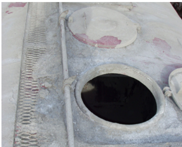
Рис. 3. Горловина загрузочного люка вагона мод. 19—1217
