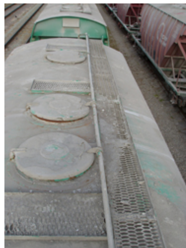
Рис. 4. Запорное устройство вагона мод. 19—1217
