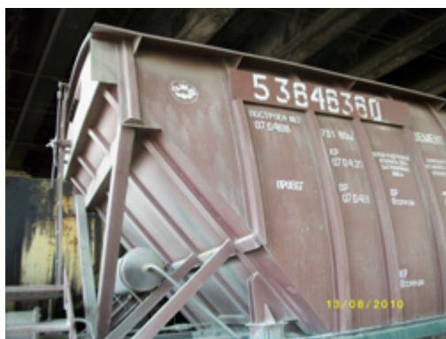
Рис. 5. Цементовоз № 53646360, находившийся 13 августа 2010 г. на станции Красный Строитель Московской дороги. Модернизированный вагон в феврале 2010 г. на ОАО «Рузхиммаш», по истечении шести месяцев, предстал в рабочепригодном состоянии
