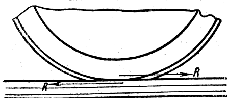
Фиг. 59. Срезающие силы при юзе
