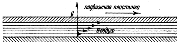
Фиг. 101. Явление вязкости воздуха
