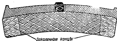
Фиг. 83. Американская чугунная тормозная колодка с включением стальной решётки
