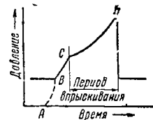
Фиг. 123. Диаграмма давлений в насосе
