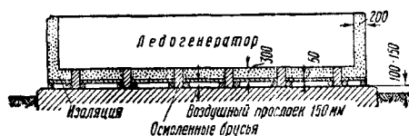
Фиг. 38. Продольный разрез изоляции бака
