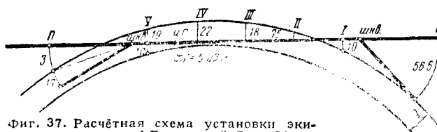
Фиг. 37. Расчётная схема установки экипажа паровоза ФД в кривой R = 400 \text{ м}
