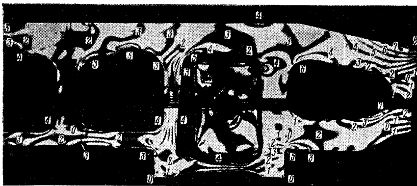
Фиг. 26. Фотография картины полос при просвечивании головной части модели рамного полотна паровоза серии Л
