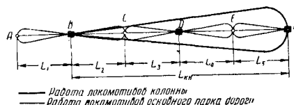
Фиг. 30. Схема работы паровозов при колонном способе езды
