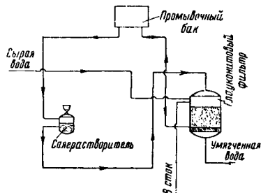
Фиг. 74. Схема катионитового метода умягчения воды
