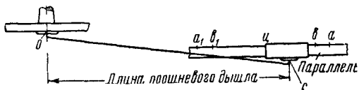
Фиг. 32. Проверка хода поршня по способу Коменко
