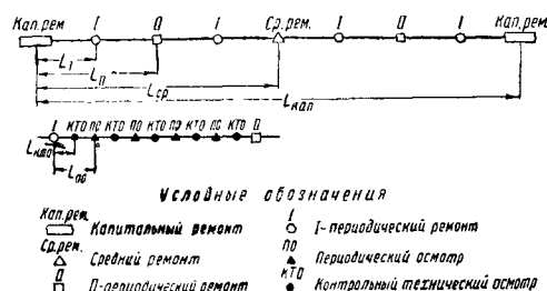
Фиг. 30. Схема периодичности осмотров и ремонтов поездных тепловозов
