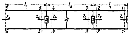
Фиг. 342. Схема трансляционной линии
