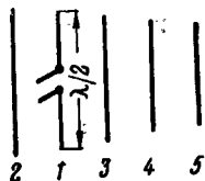
Фиг. 313. Антенна-волновой канал
