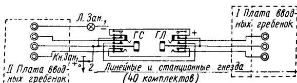
Фиг. 261. Схема комплектов для включения в испытательную стойку завода МПСС каналов тональной частоты
