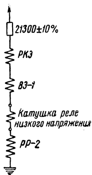
Рис. 60. Схема включения реле контроля защиты
