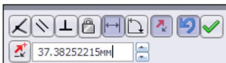
Рис. 11.7 Всплывающая панель инструментов *Сопряжение*
