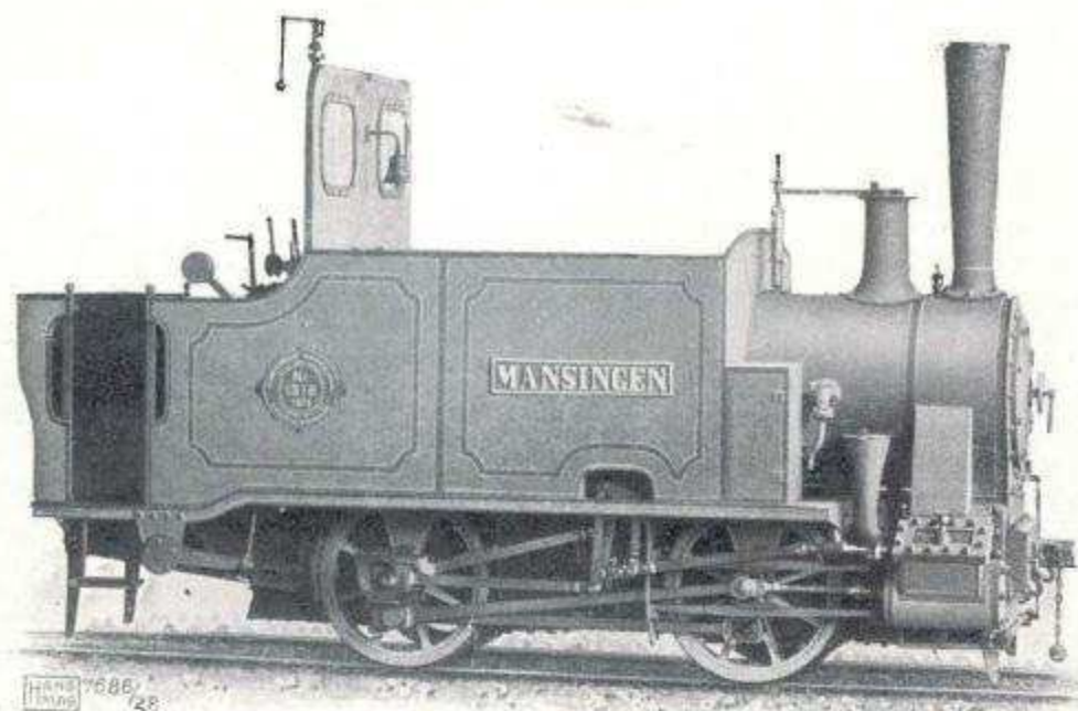
Abb. 132 B-Schmalspur-Lokomotiven für Ocholt—Westerstede. L 441 Nr. 1: „Mansingen“, Hanomag 1875, Fabr.-Nr. 1318. Nr. 2: „Burgforde“, Hanomag 1875, Fabr.-Nr. 1319.
