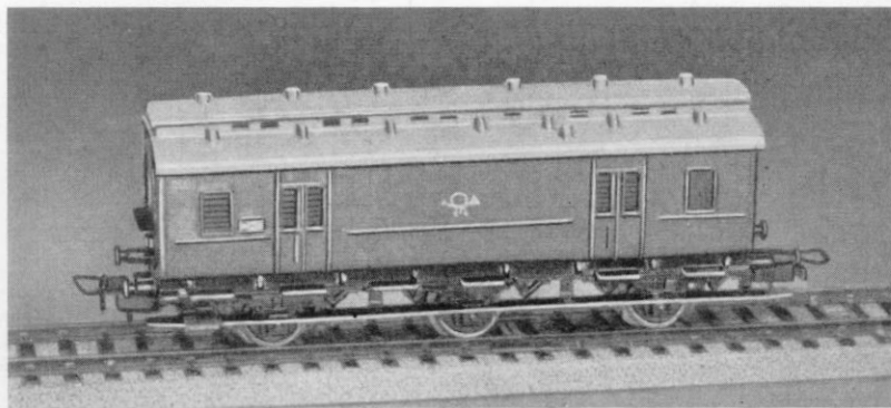
Einen Bahnpostwagen baute sich Herr Puttlitz aus Dachau in Baugröße H0 unter Verwendung eines Märklin Untergestells 330/1. Der Wagenkasten ist Selbstbau.
