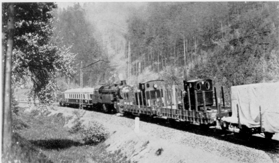
Abb. 3. Der seltene Fall, daß an die Schiebelok noch Wagen angehängt werden, hier an die - jetzt bereits ausgemusterte - bayrische Mallet-Tenderlok Gt2x 4/4 (DR-Baureihe 96) auf der Steilrampe bei Probstzella. Die Gt2x 4/4 war übrigens zu „ihrer Zeit“ (1913-25) die stärkste und schwerste Tenderlok in Europa. (Foto: Bellingrodt)
