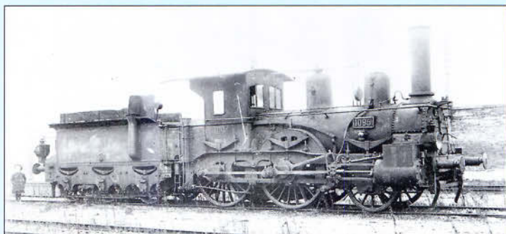
Bild 242: Aus der A 10 SULZBACH entstand in Regensburg durch Umbau die B 84 (ab 1890 bei der Staatsbahn B IX 1086).
