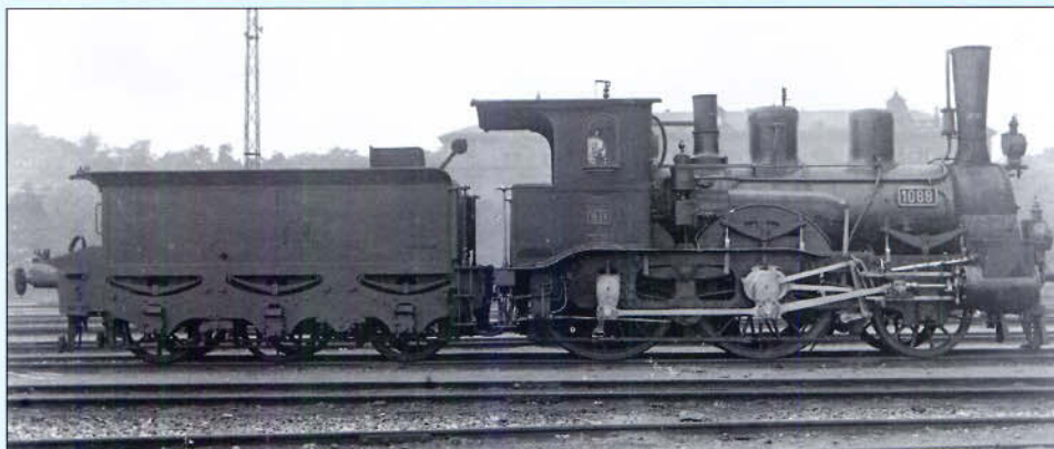
Bild 253: Die A 4 SCHLEISSHEIM wurde 1870 zur B 86 umgebaut. Sie hat zu Staatsbahnzeiten ein breites Führerhaus und Westinghousebremse erhalten.
