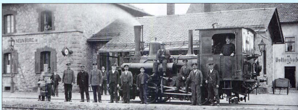
Bild 176: Die D VI EURYDICE ist auf dieser nach 1891 entstandenen Aufnahme immer noch allein mit mechanischer Bremse ausgerüstet. Abb.: Sammlung Merker Verlag
