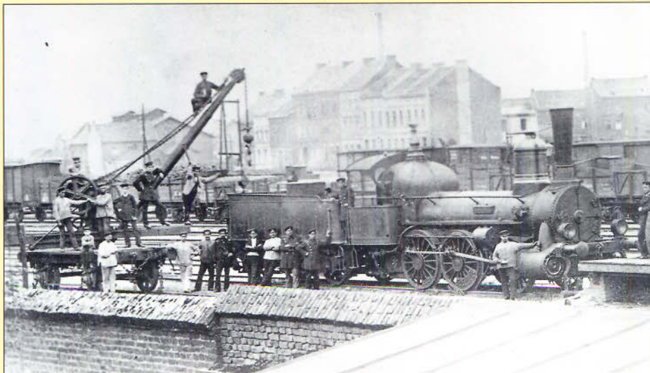
Bild 51: Bei den ab 1861 beschafften 1B-Güterzuglokomotiven kehrte die Cöln-Mindener Eisenbahn (CME) wieder zu kleinen Treibrädern (1372 mm Durchmesser) zurück. Die "Brohl" auf dieser schönen Betriebsaufnahme wurde 1863 von Borsig gebaut (Fabriknummer 1468).
