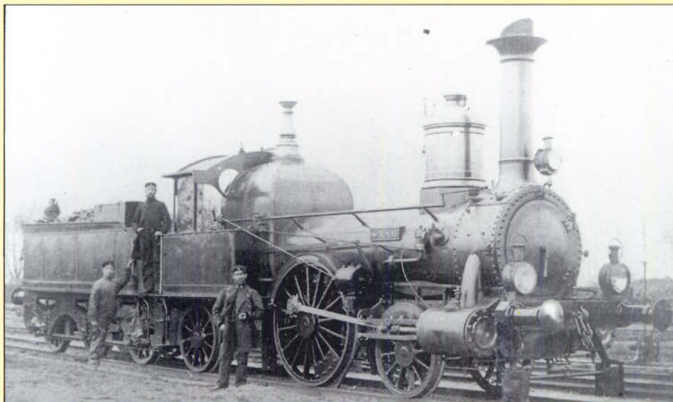
Bild 49: 1A1-Personenzuglokomotive "Saar" der Cöln-Mindener Eisenbahn aus dem Jahre 1860. Die Lok hat einen Stehkessel mit Vierseitkuppel. Die 21 Maschinen dieser Borsig-Bauform wiesen die Hauptabmessungen 381/508/1676 mm auf. Zwischen 1877 und 1885 wurden alle Lokomotiven in der Hauptwerkstätte Dortmund in 1B-Loks bzw. 1B-Tenderloks umgebaut.
