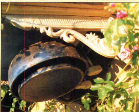
Bild 273: Doppelglocken-Konsolläutwerk von Siemens & Halske, Berlin (um 1870).
