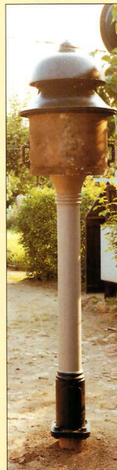
Bild 276 (oben links): Spindelläutewerk von Siemens & Halske, Berlin (ab 1870): Ansicht mit Isolatoraufsatz (Leitungszuführung) und Erdfuß.
