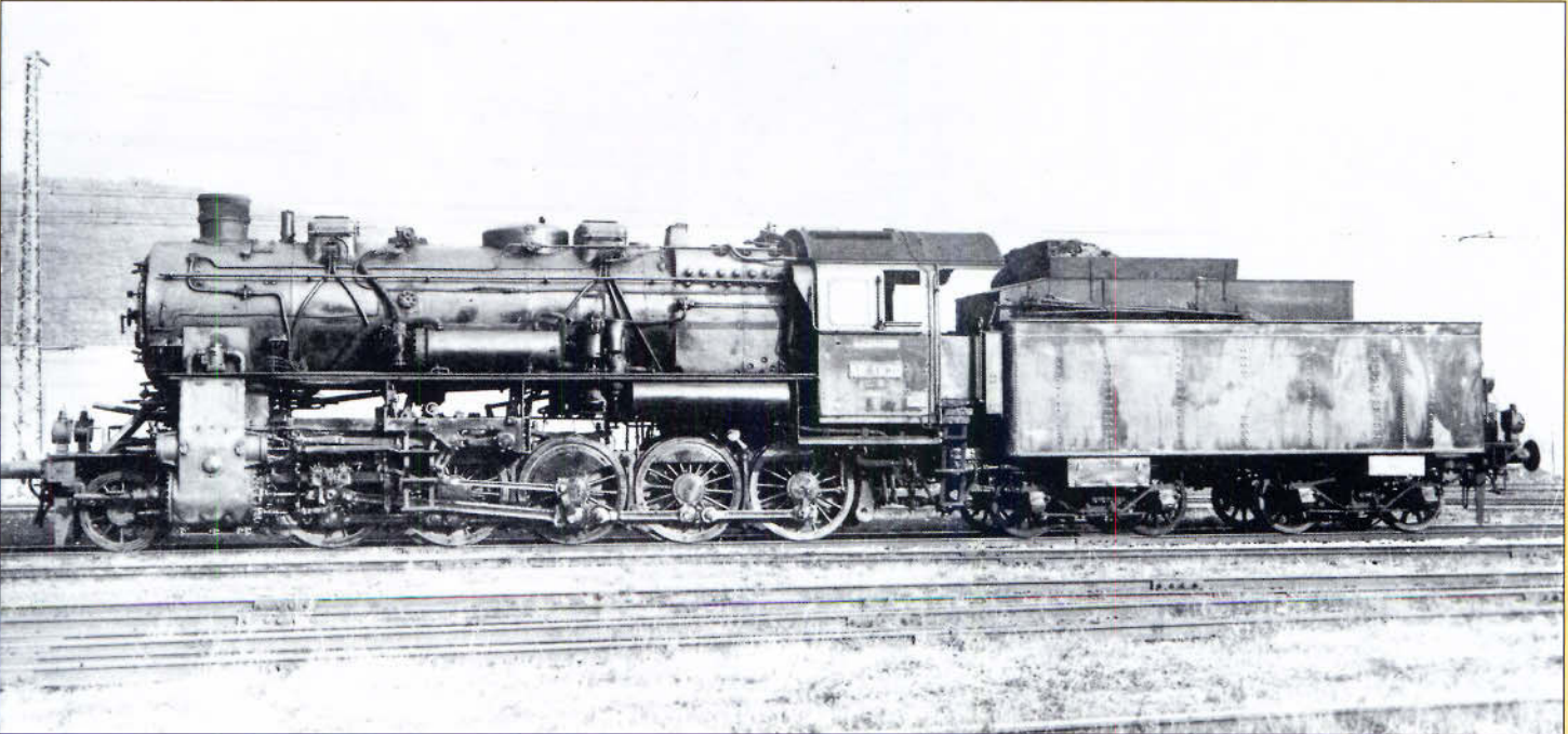
Bild 23: Eine Rarität: die 58 1830 mit Gegendruckbremse und dem vierachsigen Tender der preußischen P 8. Foto: C. Bellingrodt
