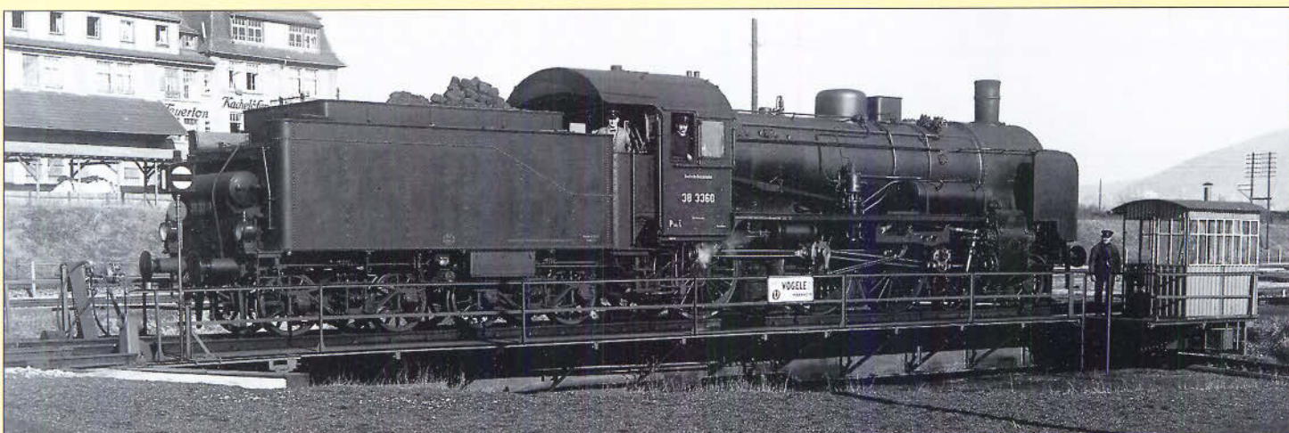
Bild 101: Der Tender 4 T 21,5 nach Musterblatt III-5I mit Fachwerk-Drehgestell war meist mit der P 8 gekuppelt.
