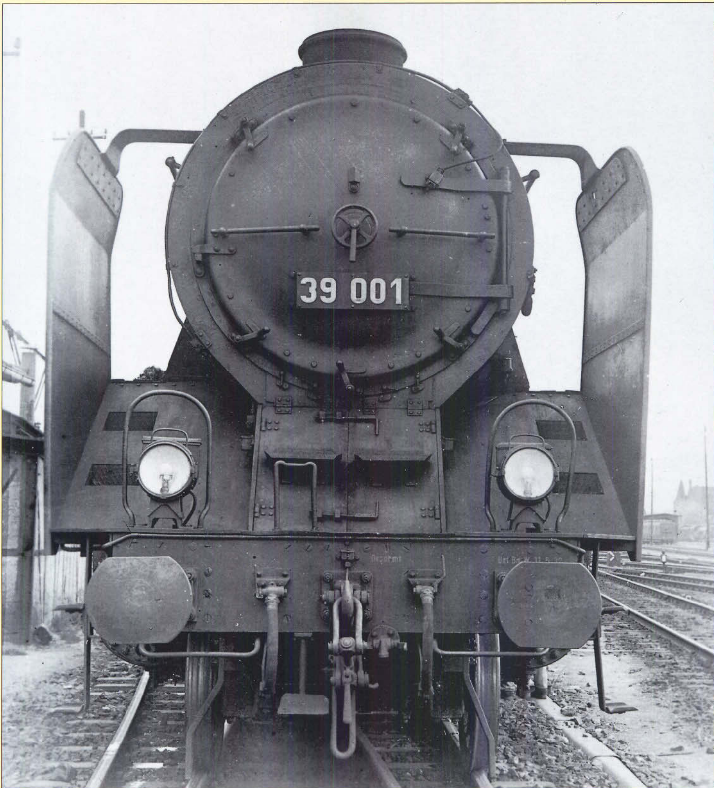
Bild 82: Das Gesicht der 39 001 mit den bauarttypischen Windleitblechen. Foto: Sammlung Dr. Scheingraber
