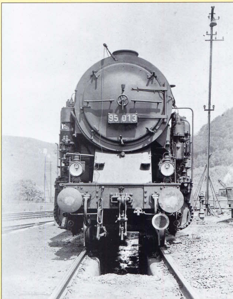
Bild 186: Stirnansicht der 95 013 mit der Überwurfkupplung für den Schiebebetrieb.
