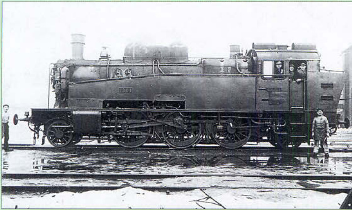
Bild 144: Die Bahnnummer 1901 des letzten Baujahrs 1921 erhielt bereits eine Kolbenspeisepumpe und eine flache Rauchkammertür.
