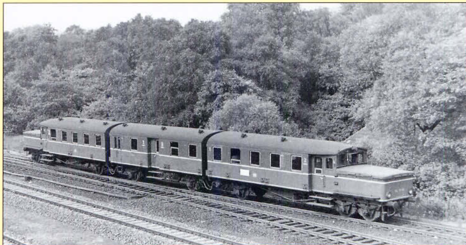
Bild 158: AT 535/535a/536 mit kurzem Mittelwagen von 9500 mm LÜP und 6000 mm Achsstand. Er wurde 1913 von der Köln-Deutzer Eisenbahnwagen- und Maschinenfabrik Van der Zypen-Charlier gebaut.
