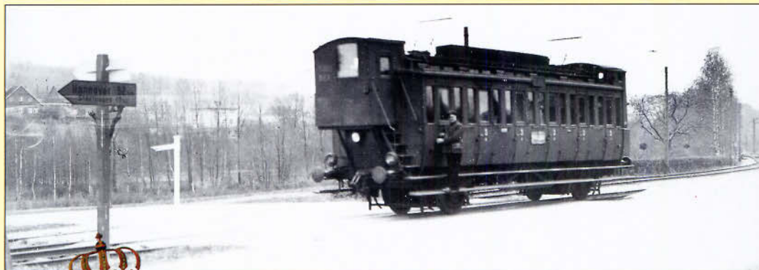
Bild 132: Eines der drei 1906 aus Berliner Stadtbahnwagen in der Hauptwerkstätte Tempelhof zu AT umgebauten Fahrzeuge war der AT MAINZ 1753. Er hieß später MAINZ 1853 und dann AT, 203. Abb. 132 und 133: Slg. Dr. Scheingraber
