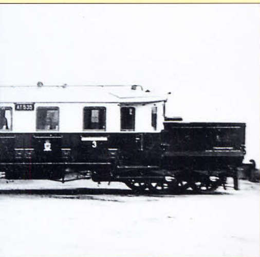
Bild 158: AT 535/535a/536 mit kurzem Mittelwagen von 9500 mm LÜP und 6000 mm Achsstand. Er wurde 1913 von der Köln-Deutzer Eisenbahnwagen- und Maschinenfabrik Van der Zypen-Charlier gebaut.
