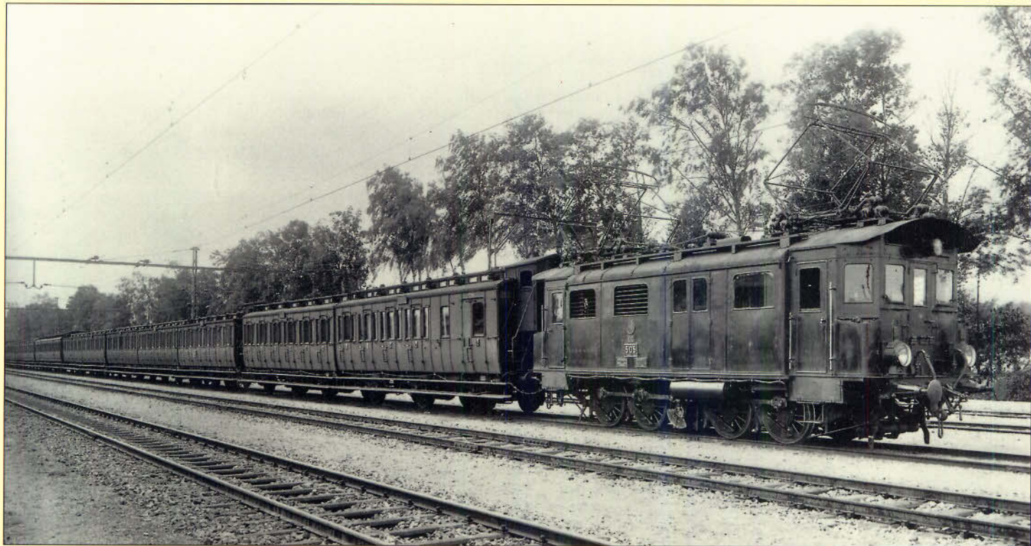
Bild 55: Im Jahr 1912 fanden mit Berliner Stadtbahnwagen Versuche zwischen Dessau und Bitterfeld statt. Neben der EB 1 bis EB 3 und EG 509/510 wurden auch lokbespannte Züge erprobt, wie hier mit EG 505 und einer gleichartigen Schwesterlok am Zugende. Abb.: Siemens Forum München
