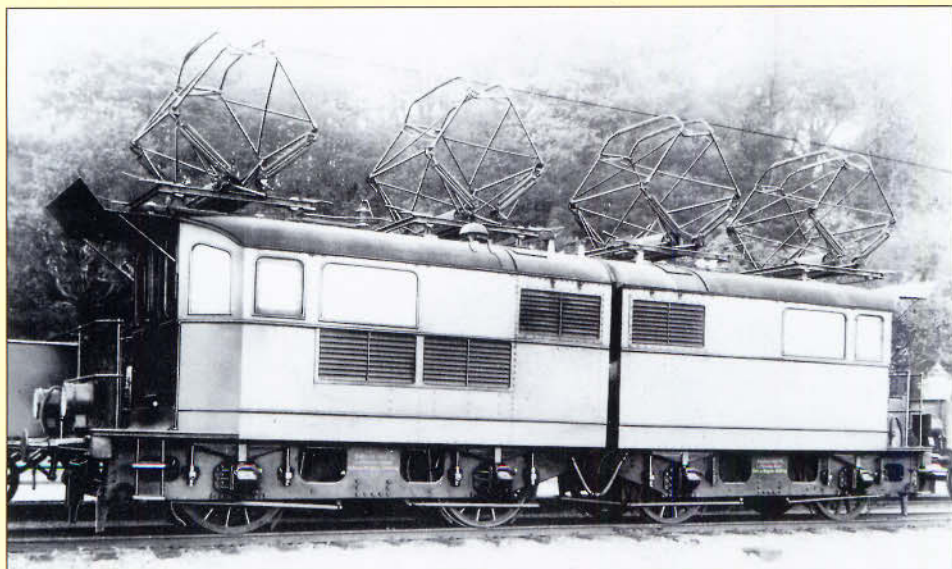
Bild 38: EV 1/2 Altona um 1912 nach ihrem Umbau, nun mit vier Stromabnehmern ausgerüstet. Abb.: Sammlung Asmus
