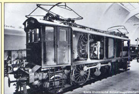
Bild 79: ES 1 in der Bahnabteilung des Deutschen Museums in München mit offener Seitenwand. Abb.: Deutsches Museum, Slg. Knipping
