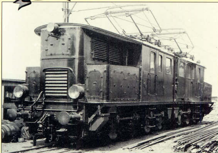
Bild 188: EG 551/552 Breslau im Anlieferungszustand des Jahres 1919, jedoch noch ohne Beschilderung. Gut zu erkennen sind die jeweils vier Hallschen Kurbeln auf jeder Drehgestellseite.
