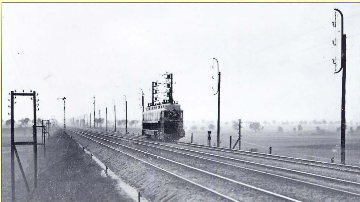
Bild 16 (linke Seite oben): (1A) (A1)-Drehstromlok (1901, Siemens & Halske) für die Versuchsstrecke Marienfelde – Zossen.
