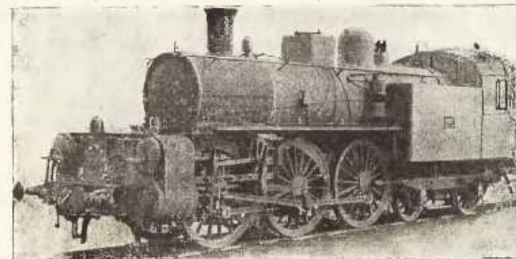
Фиг. 345. Паровоз-компаунд Южно-итальянской ж. д. завода Борзига: 1901 г.
