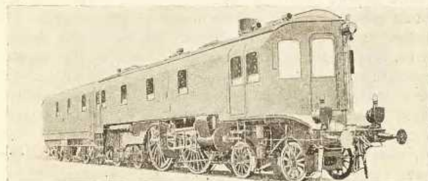
Фиг. 395. Быстроходный трехъ цилиндровый компаундъ паровозъ типа \frac{2}{6} , построенный заводомъ Геншеля въ Касселѣ. 1903 г.
