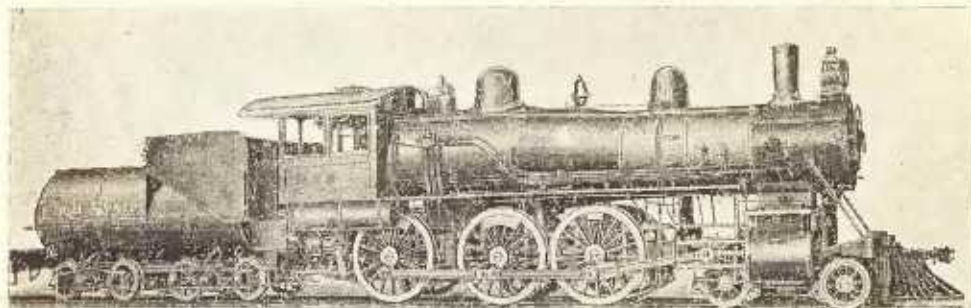
Фиг. 363. Быстроходный 4-хъ цилиндрический компаундъ паровозъ сѣти желѣзныхъ дор. Plant'a 1902 г.
