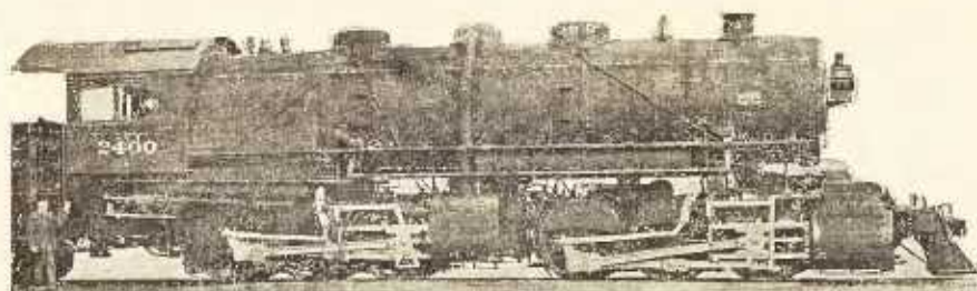
Фиг. 398. Паровозъ системы Маллета Болтимора-Огайской ж. д. Самый сильный въ мірѣ паровозъ. 1903.
