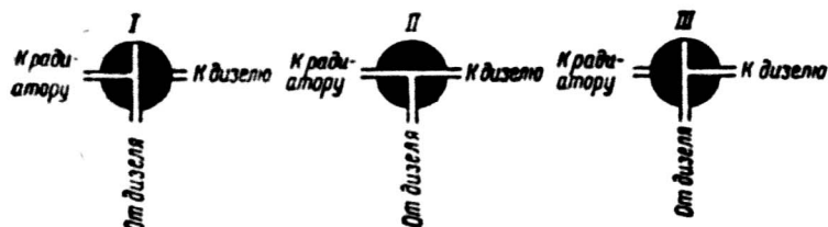
Рис. 126. Схема переключения распределительных кранов масляной системы:
