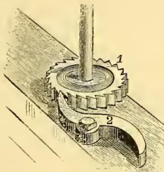
Fig. 636. (1) BRAKE RATCHET-WHEEL. (2) BRAKE-PAWL.
