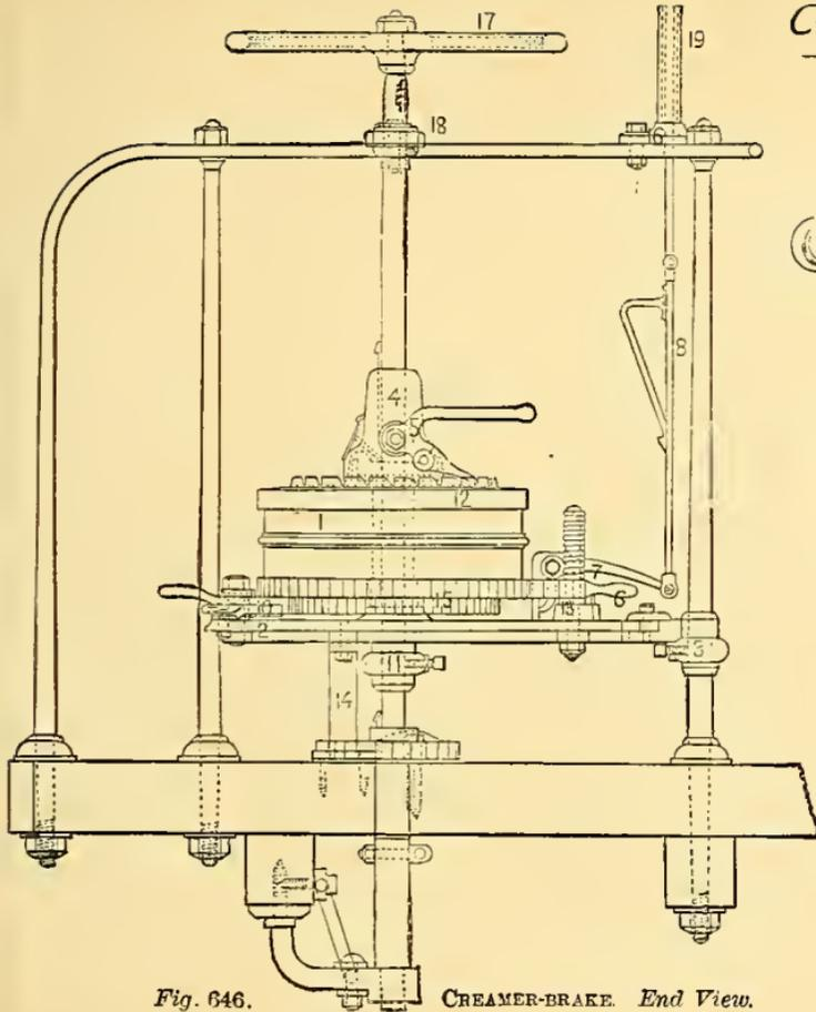
*Fig. 646.* CREAMER-BRAKE. *End View.*
