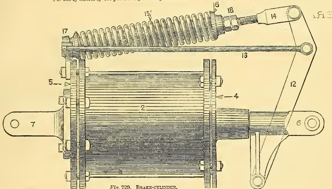
Fig. 729. BRAKE-CYLINDER,
