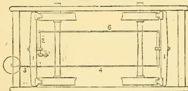
Fig. 640. BRAKE FOR DROP-BOTTOM CAR.
