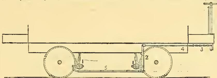
Fig. 639. COMPRESSION-ROD BRAKE.
