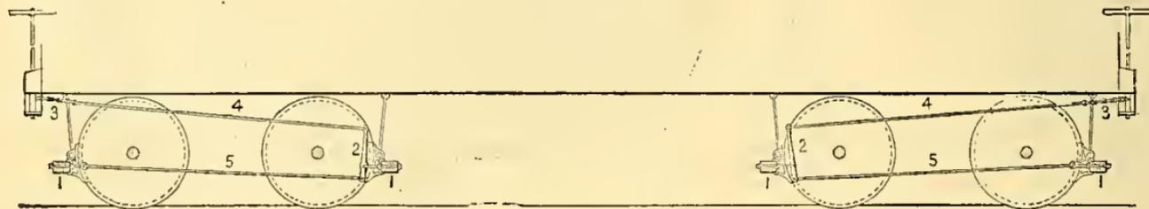
Fig. 637. SINGLE-LEVER BRAKE. Side View.
