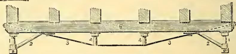
Fig. 242. CROSS-FRAME TRUSS.
