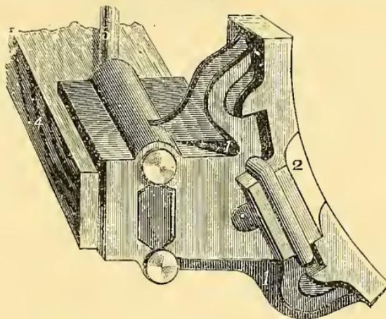
Fig. 633. BRAKE-BLOCK SHOE AND KEY.
