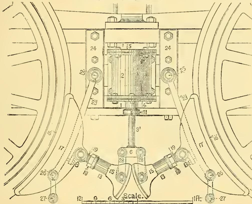
Fig. 47. Side View. WESTINGHOUSE DRIVING-WHEEL BRAKE.
