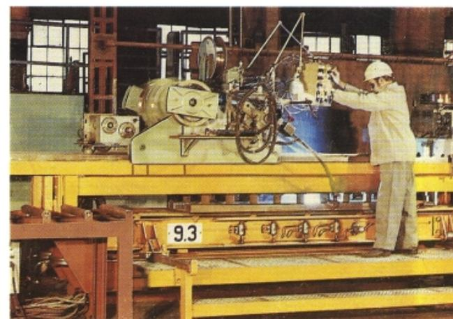
Bleche und Profile erhalten in unseren Strahlanlagen eine einwandfreie Oberflächenvorbehandlung. Klein- und Einzelteile werden in einer modernen, halbautomatischen Anlage gereinigt und oberflächenbehandelt.
