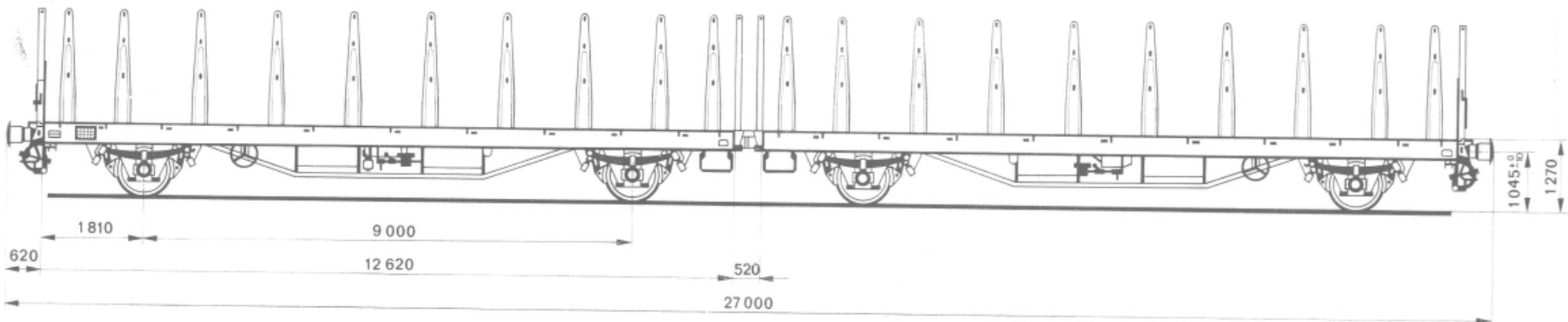
Diese Einheit ist speziell für den Transport von Straßenfahrzeugen. Der auch als universell einsetzbares Mehrzweckfahrzeug für ein- und doppelstöckige Beladung vorgesehen. Damit ist der Transport von Straßenfahrzeugen unterschiedlicher Größen- und Gewichtsklassen, sonstigen Stück- und sperrigen Ladegütern einschließlich ISO-Containern möglich.
