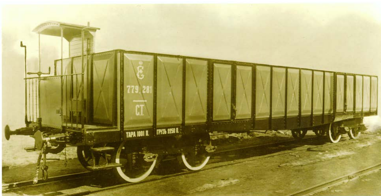
4-осный угольный тормозной полувагон системы Фокс-Арбель. 1908–1912 гг.
