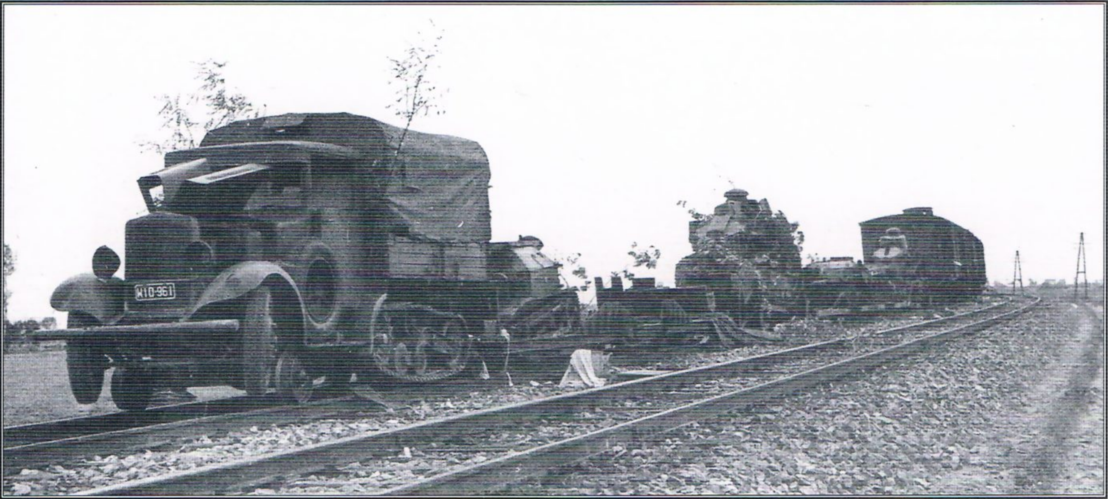
Dwa czołgi Renault FT, dwie tankietki TK-3 i samochód półgąsienicowy wz. 34 przystosowany do jazdy po torach kolejowych z plutonu drezyn pancernych pociągu pancernego nr 13 porzucone w okolicach Torunia we wrześniu 1939 roku. Na platformach nie ma dwóch etatowych tankietek, zaś na końcu widoczny wagon Kd. Two Renault FT tanks, TK-3 tankettes and a half-tracked Model 34 truck fitted with rail chassis of the armoured dresines platoon attached to the Armoured Train No. 13 abandoned in Torun area in September 1939. Note lack of two TK-3 tankettes, background is a Kd wagon. [Delta Publishing]
