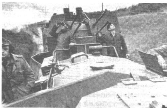
Pociąg pancerny BP 42 – Artillerie und Flakwagen. Widoczne działko 2 cm Flakvierling 38. Armoured train BP 42 type. Note 2 cm Flakvierling 38 AA Gun [WT]
