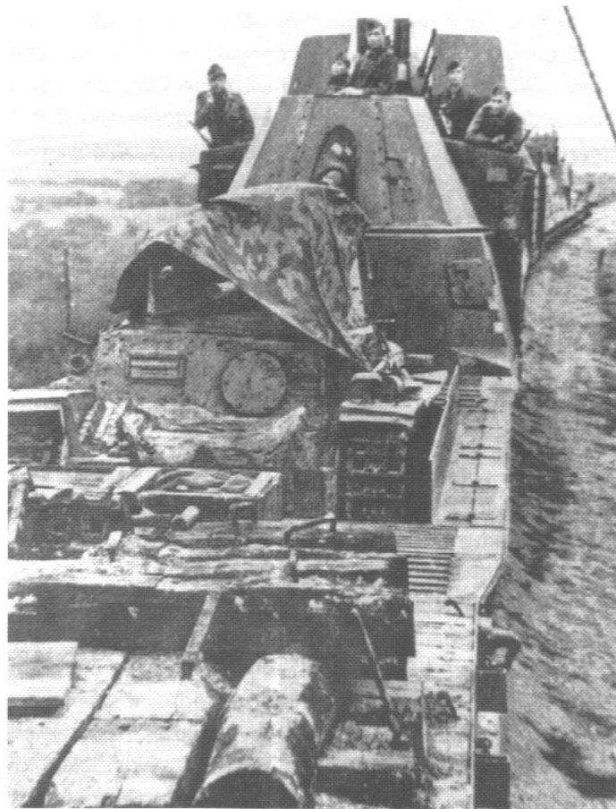
Pociąg pancerny Nr. 62, widoczny Panzerträgerwagen z czołgiem PzKpfw 38(t) Ausf. G, marzec 1944 roku. The Nr. 62 armoured train, March 1944. Note Panzerträgerwagen with PzKpfw 38(t) Ausf. G tank [WT]
