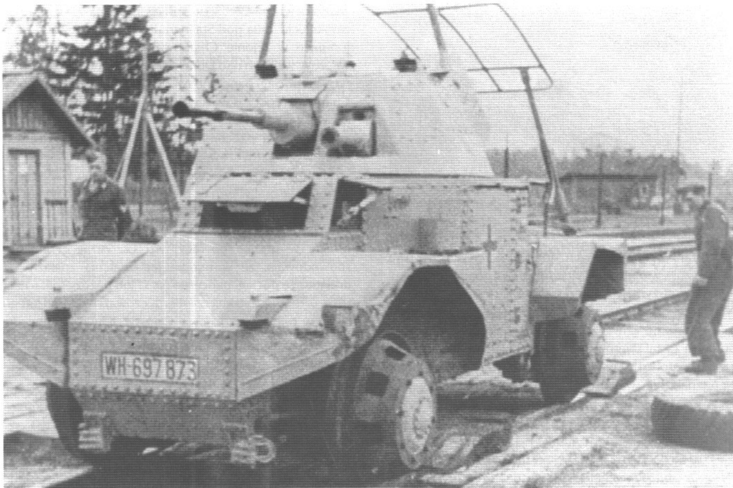
Samochód pancerny Panhard 204(f) przystosowany do jazdy po szynach. Samochody tego typu były używane jako drezyny rozpoznawcze pociągów pancernych. A recce armoured car Panhard 204(f) [Tank Museum]
