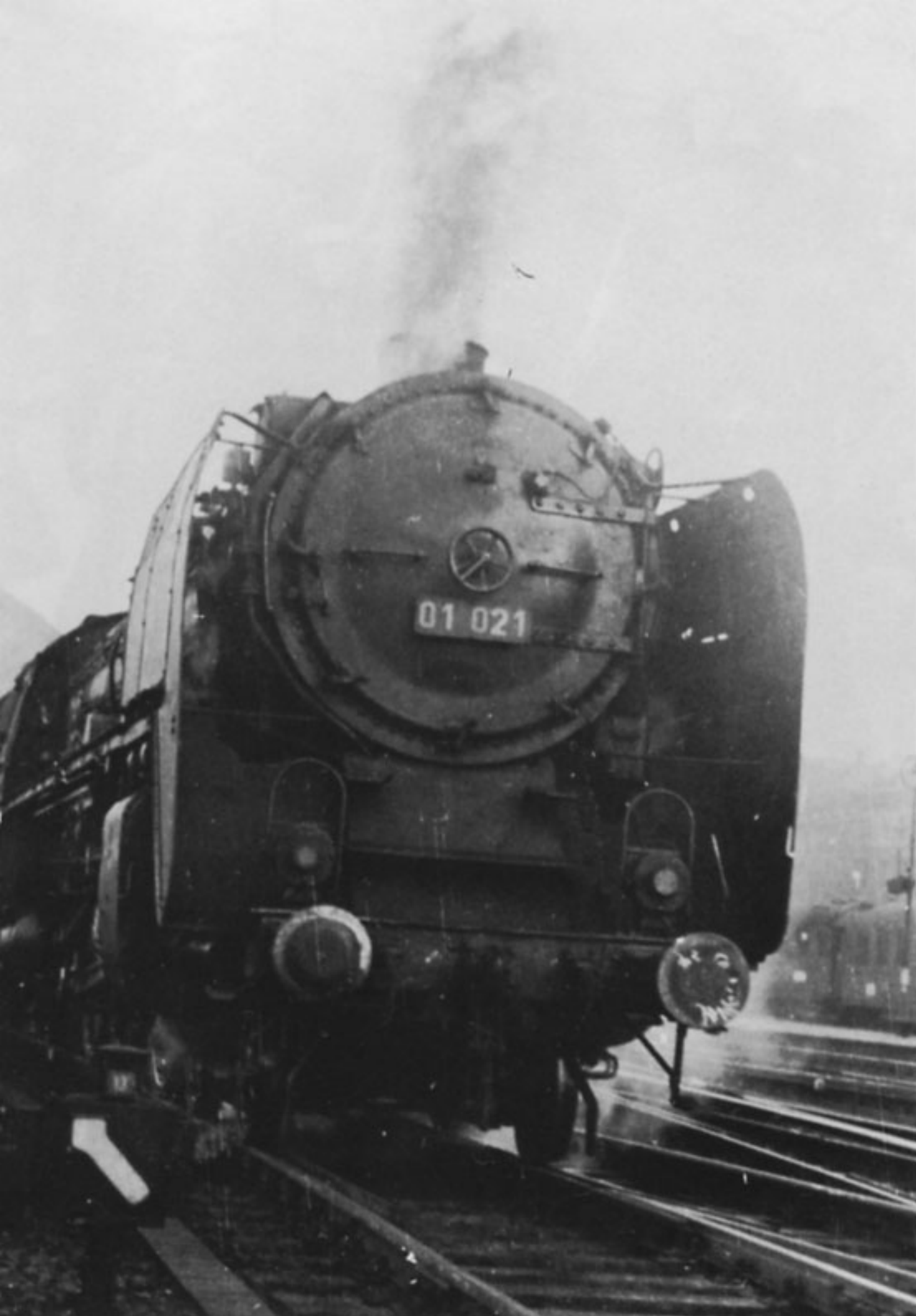
Oben, links: Berlin Anhalter Bahnhof, Herbst 1940: Schnellzuglok der Baureihe 01 0 , Bauart 2C1-h2, Gattung S 36.20, Baujahr 1925. Abgedunkelte Lampen
