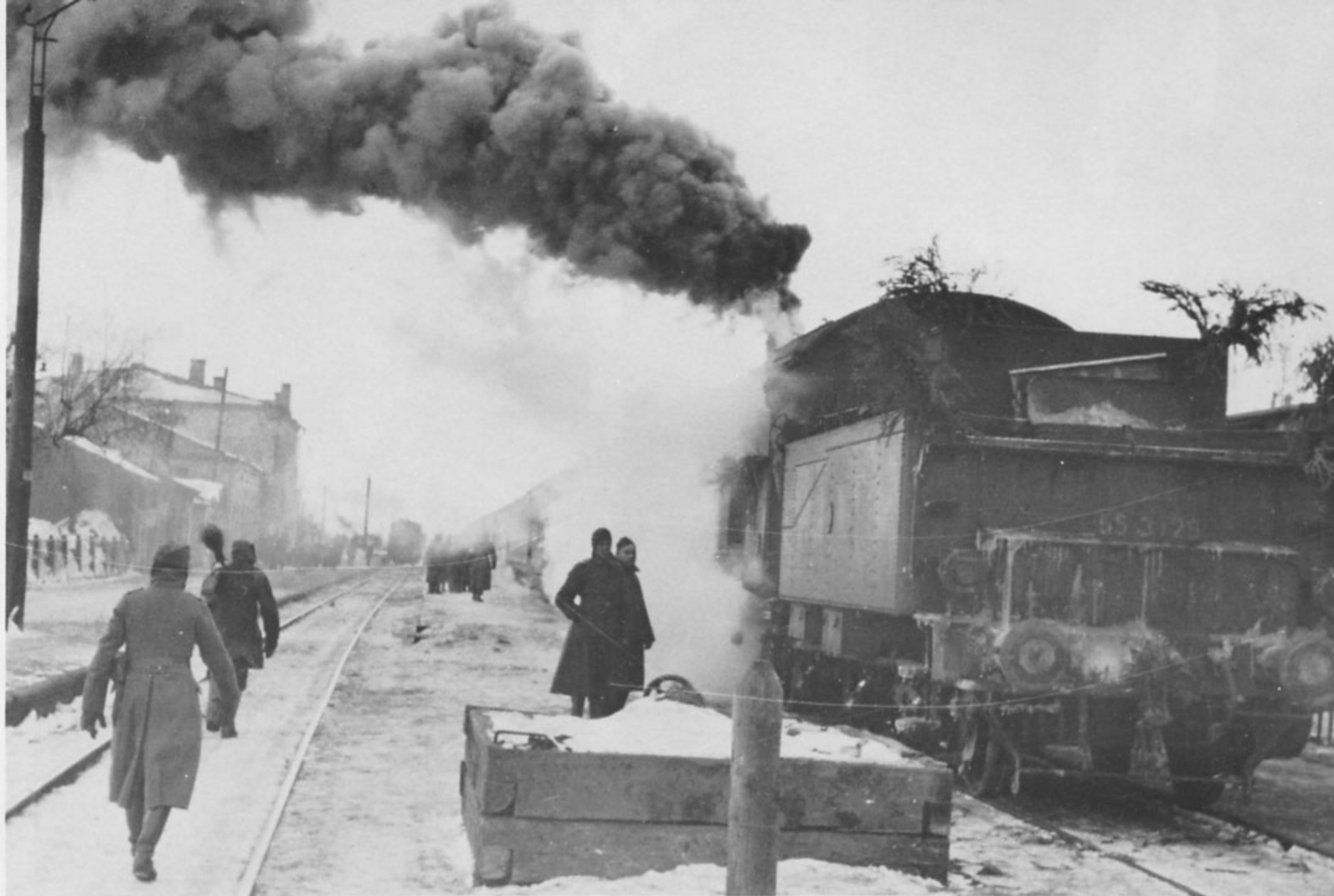
Malin, westlich von Kiew, Dezember 1942: Eine Gü- terzuglok, der Baureihe 55 25 mit Frostschutzver- kleidung um die Pumpe und Fronttarnung steht unter Dampf
