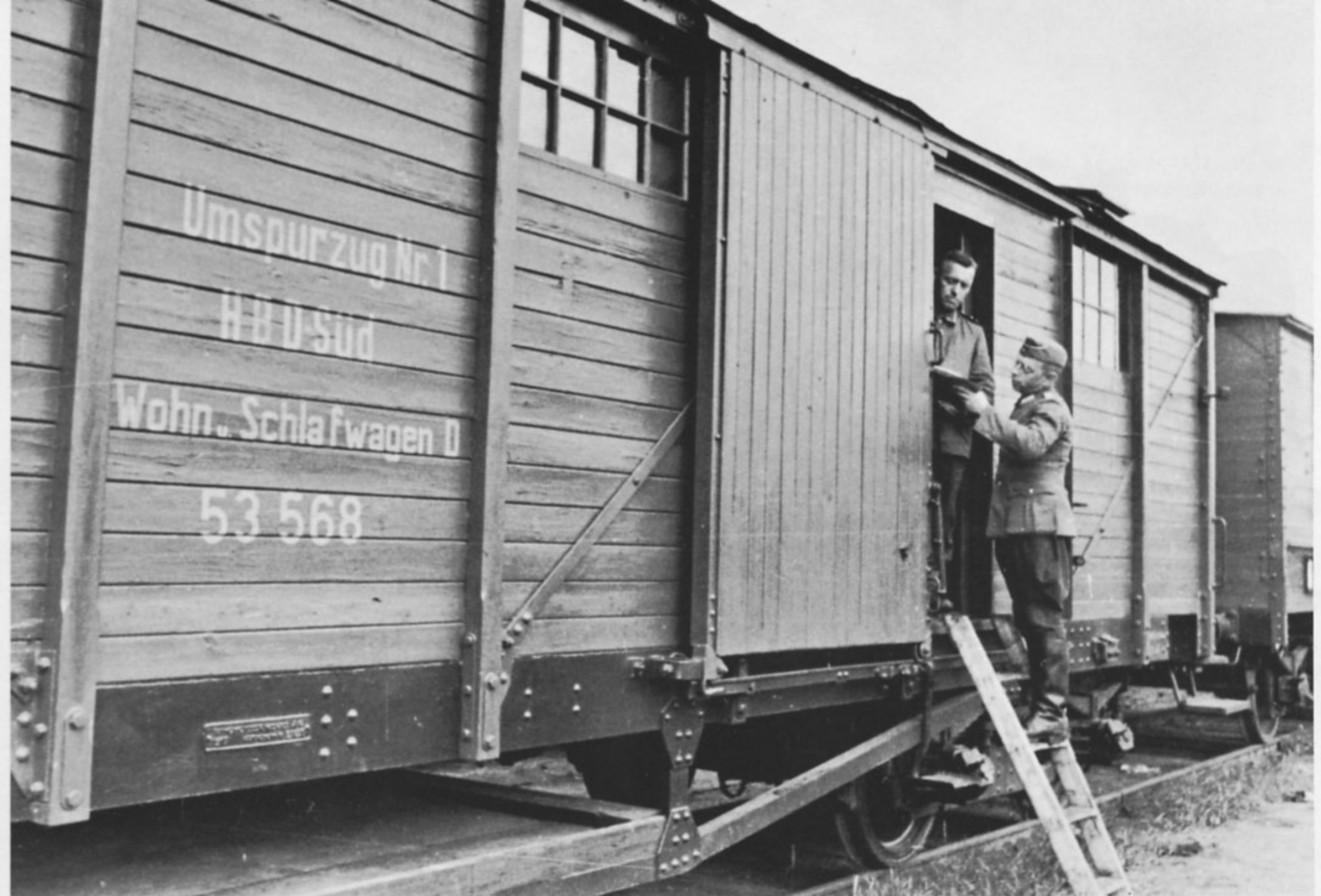
10 000 km umgenagelte Schienen: Umspurzug der Hauptseisenbahn- Direktion Süd (Kiew). Der Vierach- ser-Güterwagen von 1917 als Wohn- stätte der Eisen- bahnpioniere
