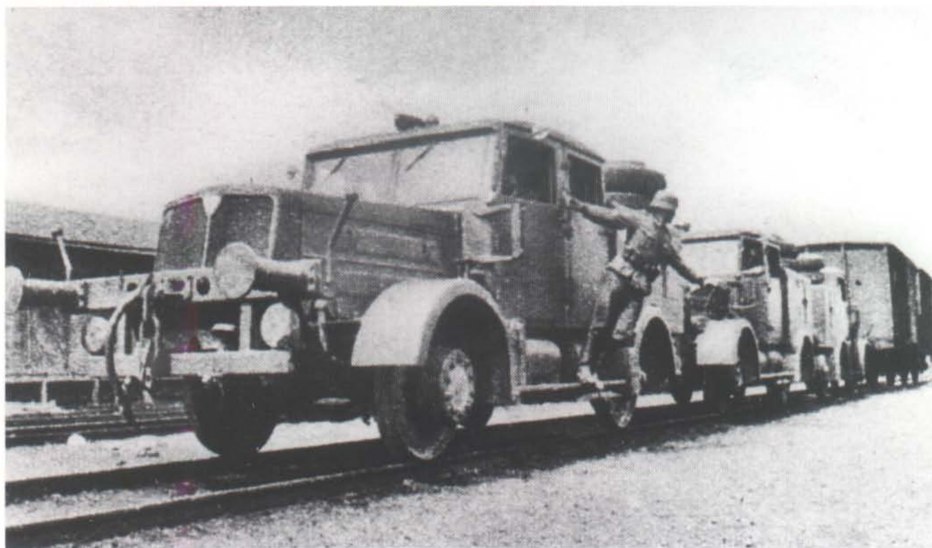
Auf dem noch nicht umgenagelten Schienen können nicht nur sowjetische Lokomotiven und Eisenbahnwagen verkehren, sondern auch Spezialkraftwagen (Schienenschlepper) der Eisenbahnpioniere. Die Spurweite dieser Schlepper konnte durch Verlegung des Radkranzes je nach Bedarf auf die Normalspurweite bzw. die sowjetische Spurweite eingestellt werden.
