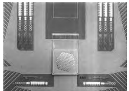
Фото 15. Гексагональное зеркало, созданное из более мелких микрозеркалец-ячеек
