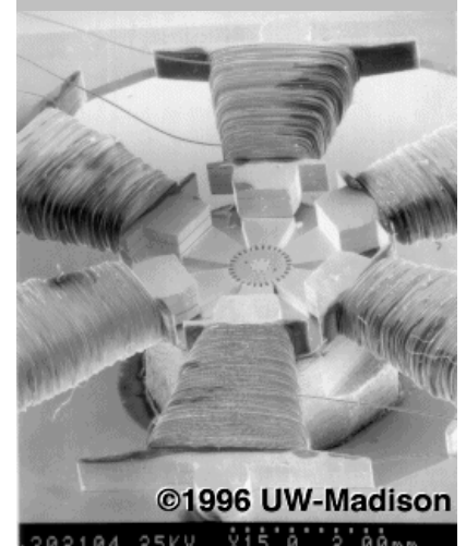
Фото 12. Индуктивные катушки микромоторчика с 6.800 витками провода на каждой
