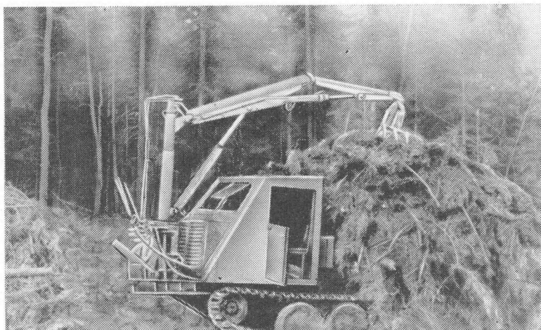
Рис. 10. Погрузчик ПГ-0,5Д, смонтированный на трелевочном тракторе
