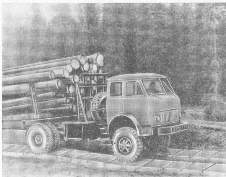
Рис. 32. Вывозка древесины по усам с покрытием ЛД-5
