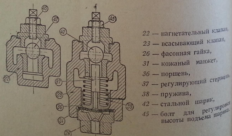
Рис. 84. Шариковый клапан.
