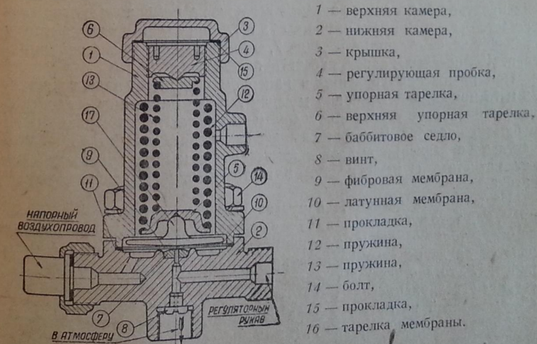
Рис. 91. Регулятор давления.
