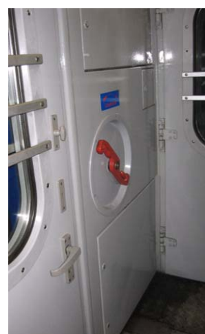
Рис.5.34. Привод ручного тормоза.
