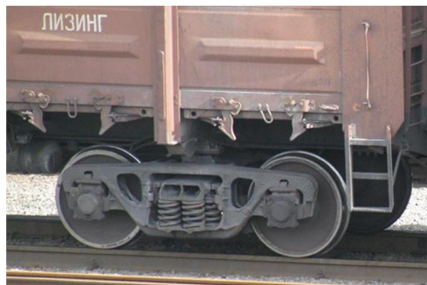
Тележка грузового вагона
