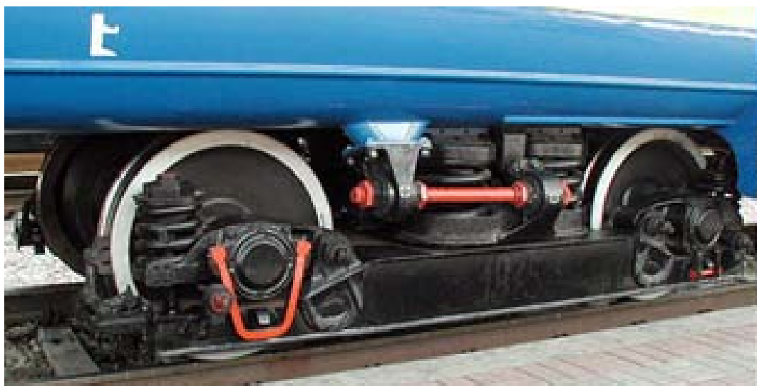
Пассажирская тележка модели KB3-ЦНИИ-М.
