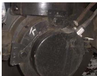
Букса с термодатчиком.
