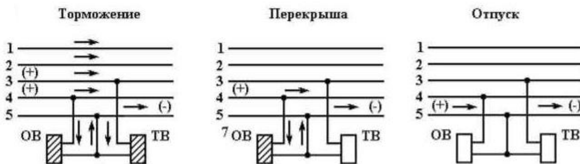
Рис. 5.40. Пятипроводная схема ЭПТ
