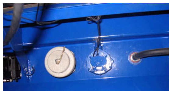
Межвагонная радиотрансляционная розетка.
