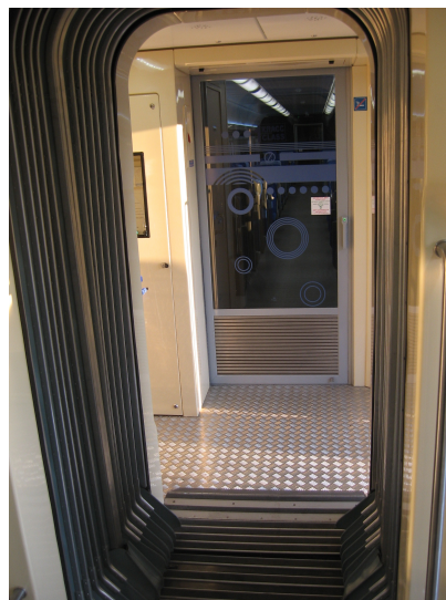
Упругая площадка с защитным элементом типа “гармошка”
