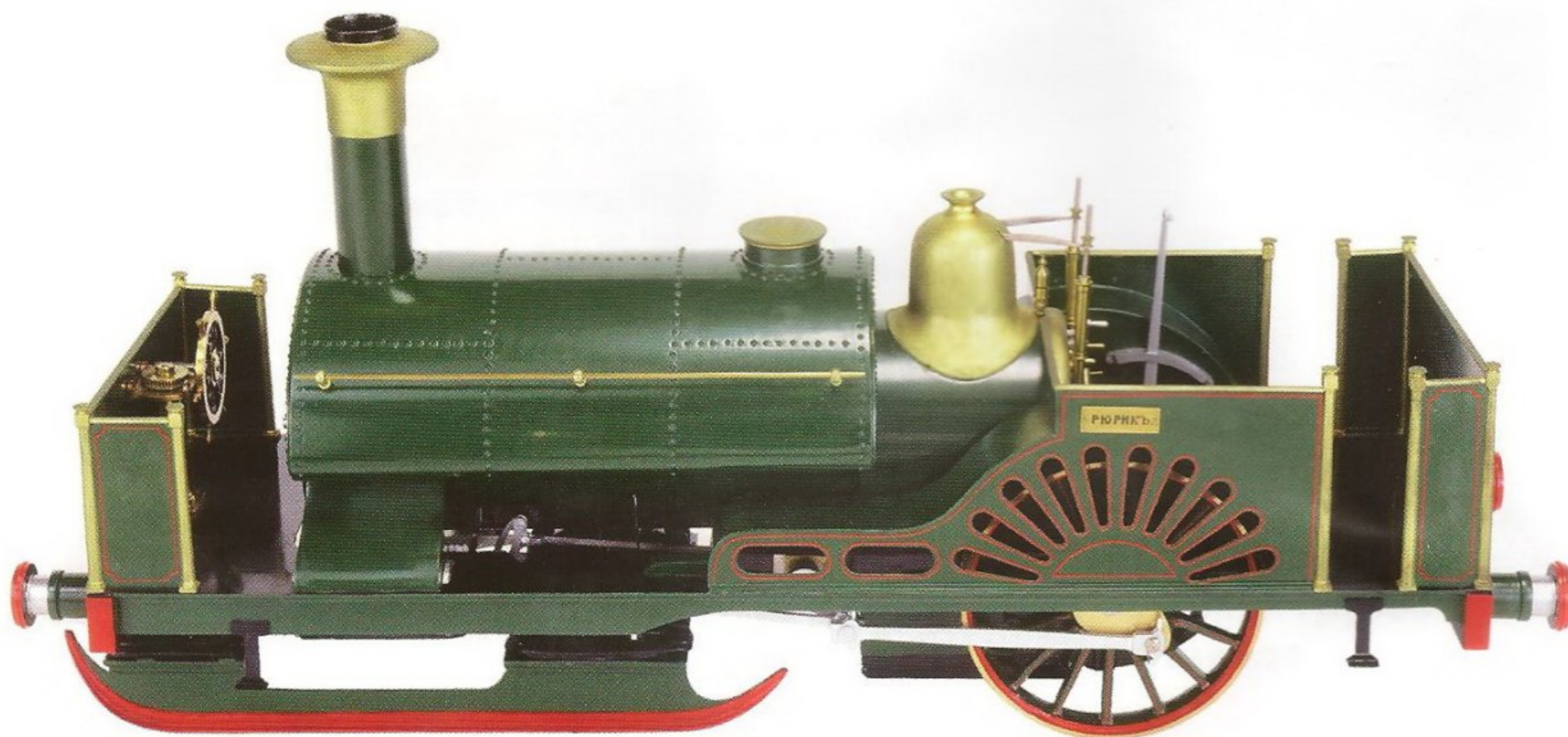
▲ Модель локомотива, сконструированного компанией Neilson & CO из Глазго в 1861 году специально для путешествий по замерзшим рекам России. В дополнение к направляющим полозьям, он снабжен двумя колесами со стальными шипами, чтобы улучшить сцепление со льдом. Машина управляется с помощью колеса, похожего на штурвал корабля, расположенного в передней части. Локомотив постоянно использовался для перевозки пассажиров и грузов по российским рекам зимой 1861-1862 годов.
