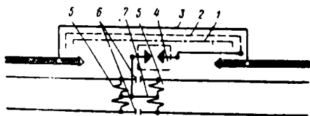
Фиг. 2. Схема соединения оболочек кабелей контактной сети с ходовыми рельсами через искровой промежуток: 1—броня; 2—свинцовая оболочка; 3—жила кабеля; 4—искровой промежуток; 5—путевые дроссели; 6—изолированные стыки; 7—нулевая точка
