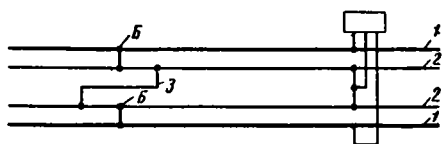
Фиг. 10. Неправильный выбор точки измерения r_n : 1 — контактные рельсы; 2 — ходовые рельсы; 3 — междупутная перемычка
