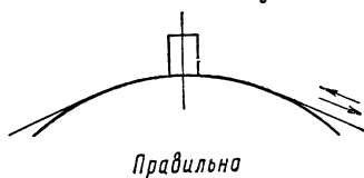
Рис. 256. При- тирка щеток к коллектору
