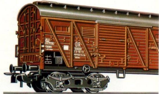
5/132-015 Modell des gedeckten Güterwagens der DR Bauart GG 15 mit Stirnwandtüren, LüP: 180 mm
