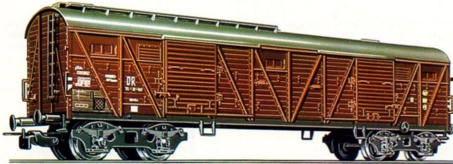
5/132-01 Modell des gedeckten Güterwagens der DR — Bauart GG 15, LüP: 180 mm
