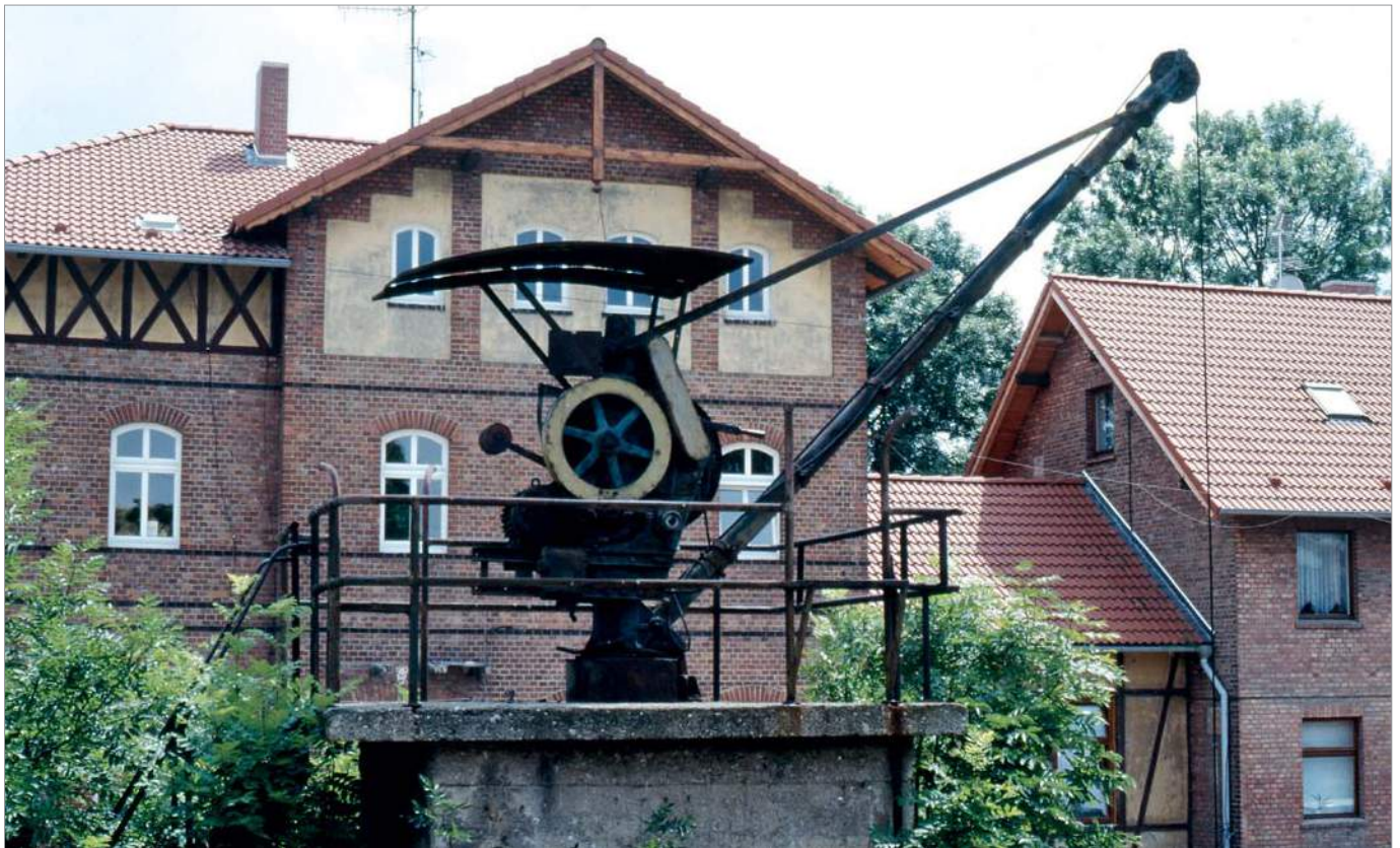
Dieser Säulendrehkran auf einem Betonsockel „überlebte“ im Lokbahnhof Hessen noch bis weit nach 1989, weil die Deutsche Reichsbahn die einstige Kleinbahn bis in die Nähe der Staatsgrenze West aus militärischen Gründen erhalten musste. Foto: Michael U. Kratzsch-Leichsenring
