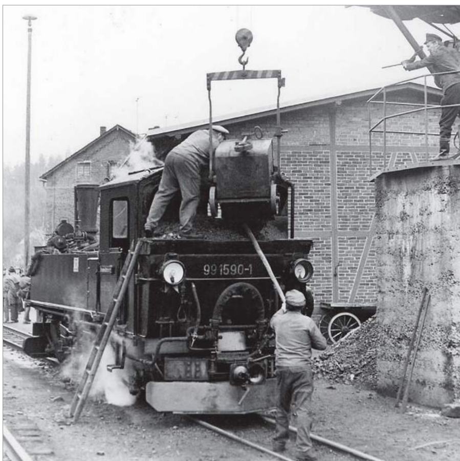
Bekohlungsanlagen ohne Lokbahnhöfe: Auch mit Kohlekran waren sowohl in Wilkau-Haßlau (Foto oben am 16. Mai 1973) als auch in Schönheide Süd (am 4. Mai 1975) drei Arbeitskräfte (zwei an der Lok) erforderlich, um die Kohle richtig zu platzieren. Fotos: Rainer Heinrich
