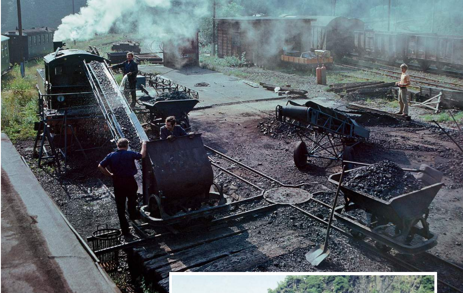
Im Lokbahnhof Wolkenstein (Fotos oben und rechts) wurde die Lokomotivkohle mit 500-mm-Feldbahnloren transportiert.
