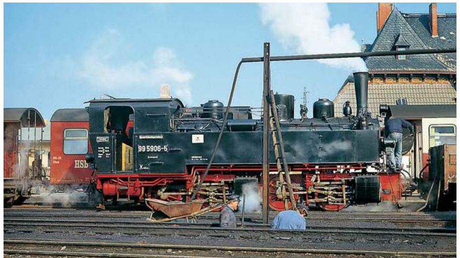
Löscheziehen im Lokbahnhof Gernrode der HSB. Die beiden „halben“ Eisenbahner vor der 99 5906 reinigen den Kanal von den unvermeidlichen Verbrennungsrückständen. Foto: Michael U. Kratzsch-Leichsenring.
