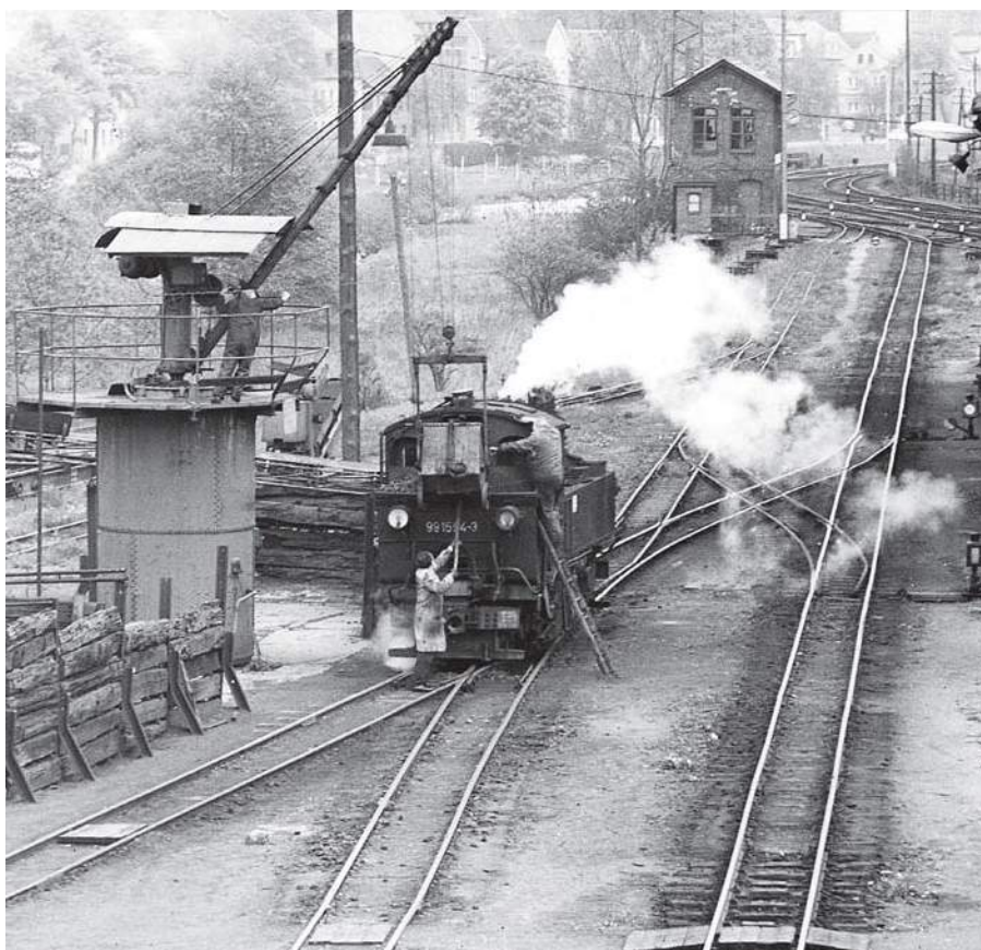
Bekohlungsanlagen ohne Lokbahnhöfe: Auch mit Kohlekran waren sowohl in Wilkau-Haßlau (Foto oben am 16. Mai 1973) als auch in Schönheide Süd (am 4. Mai 1975) drei Arbeitskräfte (zwei an der Lok) erforderlich, um die Kohle richtig zu platzieren. Fotos: Rainer Heinrich
