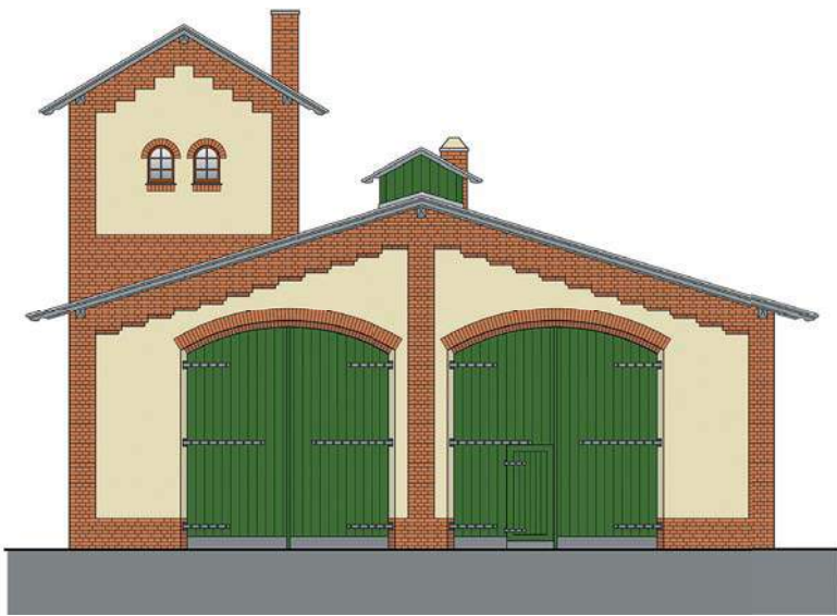
Nordseite mit den beiden Einfahrten und Westseite des zweigleisigen, zweistöckigen Lokschuppens der Kleinbahn Ziesar–Görzke im Hohen Fläming: Die architektonische Gestaltung des mit Wasserturm und Werkstattanbau versehenen Gebäudes weist Parallelen mit dem Lokschuppen in Colbitz auf. Zeichnungen: Lutz Kuhl
