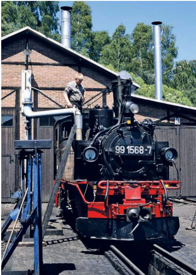
99 1568 der Preßnitztalbahn nimmt im Lokbahnhof Jöhstadt Wasser. Unmittelbar vor der Lok ist die Untersuchungsgrube sichtbar. Foto: Dirk Endisch
