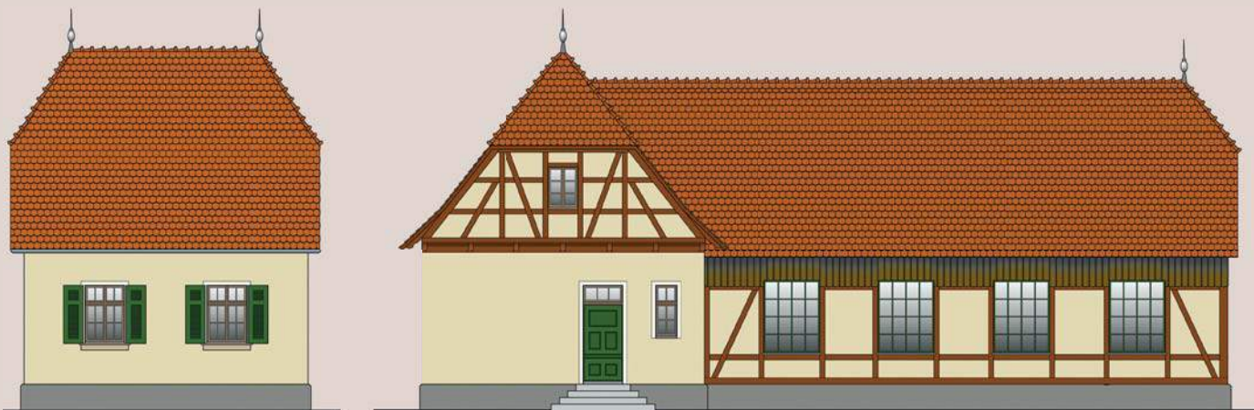
Eingleisiger Lokschuppen in Heiligenstadt am Endpunkt der Lokalbahn Forchheim–Ebermannstadt–Heiligenstadt: Das quer zur Symmetrieachse des Lokschuppens errichtete Gebäude diente Wohnzwecken – eine in ganz Bayern auch bei eingleisigen Lokschuppen sehr verbreitete Baugestaltung. Der Baustil des 1915 errichteten Ensembles folgte mit seinem Sichtfachwerk, den sauber verputzten Gefachen, der Farbgebung und den hohen, steilen Krüppelwalmdächern etwas romantisierend der ländlichen Bauweise Oberfrankens. Zeichnung: Lutz Kuhl
