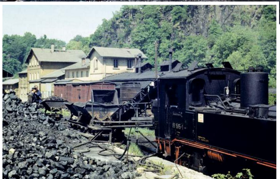
Im Lokbahnhof Wolkenstein (Fotos oben und rechts) wurde die Lokomotivkohle mit 500-mm-Feldbahnloren transportiert.
