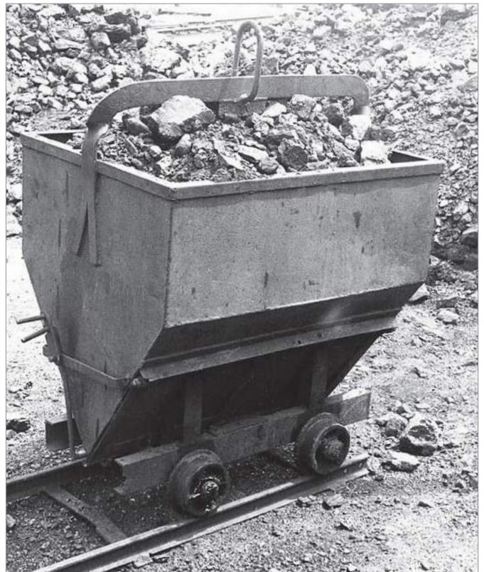
Dieser Kohlehunt, den Wolfgang List Ende der 1960er-Jahre in einem altmärkischen Lokbahnhof fotografierte, lief auf Radsätzen mit Spurkranzen auf Feldbahngleisen. Mit seiner trichterartigen Form ließ er sich über dem Tender der Lok durch Klappen nach unten entleeren.
