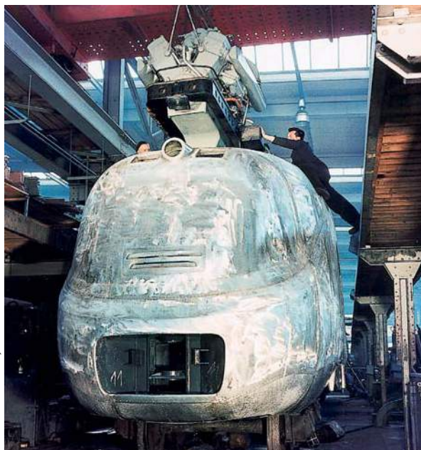
„Hochzeit“ für einen VT 11.5-Triebkopf: Der Fahrmotor Maybach MD 650 wird eingebaut.
