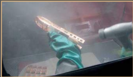
Die verkupferten Gehäuse müssen noch speziell fürs Goldbad vorbereitet werden.
