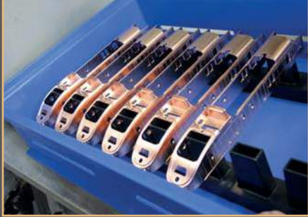
Die Weißmetall-Rohlinge werden in einem ersten Arbeitsgang galvanisch verkupfert.
