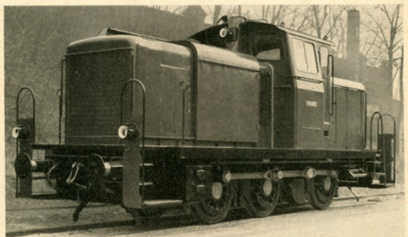
280 neue Rangier-Diesellokomotiven der Baureihe V 60 hat die DB bei der deutschen Industrie in Auftrag gegeben. Es handelt sich hierbei um eine dreischichtige Stabrahmen-Lokomotive mit Blindwelle und Stangenantrieb mit halbmittig angeordnetem Führerhaus. Technische Daten: 650 PS-Dieselmotor, Flüssigkeitsgetriebe mit mechanischem Nachschaltgetriebe für Vorwärts- und Rückwärtsfahren und zur Einstellung der Geschwindigkeiten von 30 oder 40 km/h, Länge 19,5 m, Breite 3,1 m, Achsdruck 16 t, Gesamtgewicht 48 t. Ein ausführlicher Bericht über dieses neue Triebfahrzeug folgt.
