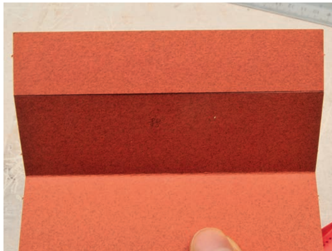
In gleicher Weise wird die Ziegelplatte bearbeitet. Deutlich sind die verschiedenen Neigungswinkel und die Spuren des Cutters zu erkennen.
