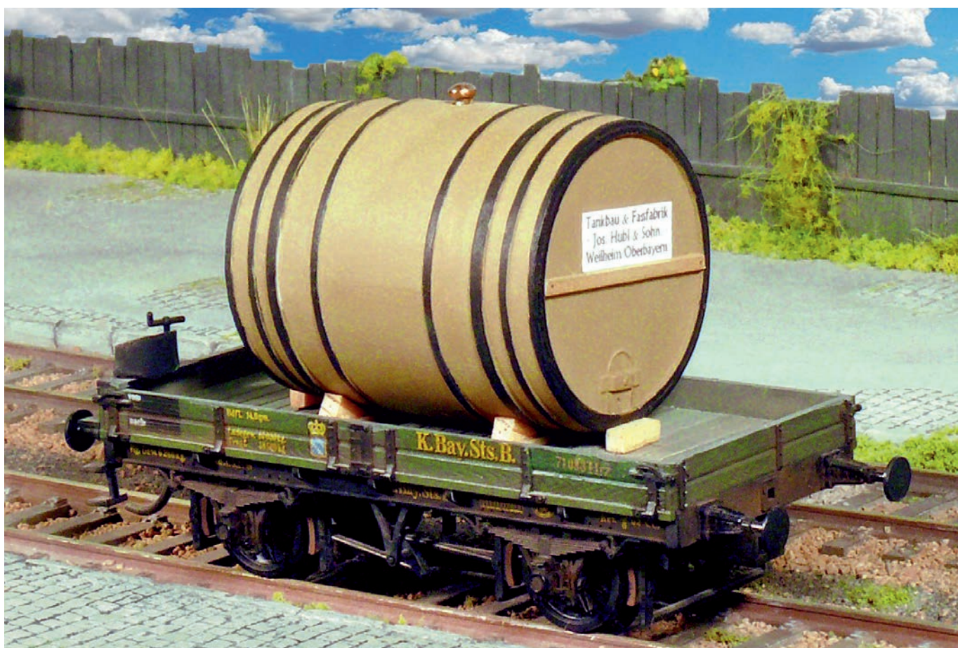
Mit Keilen und Bohlen: So gesichert, kann ein Großfass auch in der Epoche II und III verladen werden.
