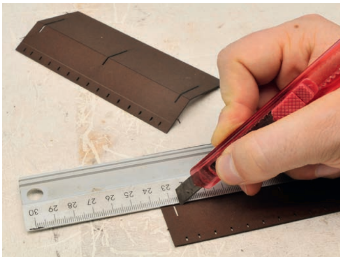
Um die Dach-Trägerplatten an die neue Dachform anzupassen, werden sie zunächst rückseitig vorsichtig eingeritzt und dann nach außen geknickt.
