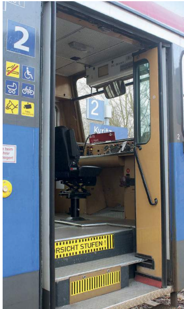
Als niederflurig noch nicht verlangt war: Einstiegsbereich und Führerpult des VT 120
