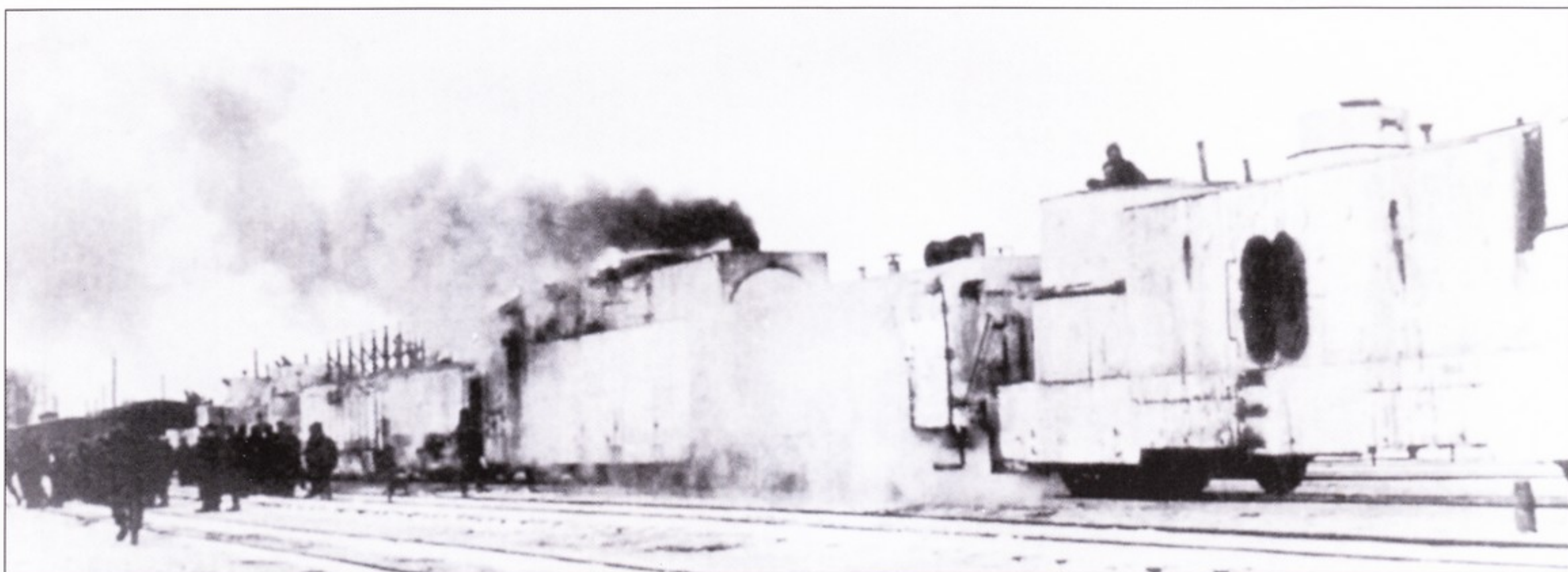
Из трофейных польских бронепоездов сформирован и направлен на Восточный фронт бронепоезд PZ 21. Бронированная коробка немецкого паровоза № 93 298 примитивной угловатой формы.
