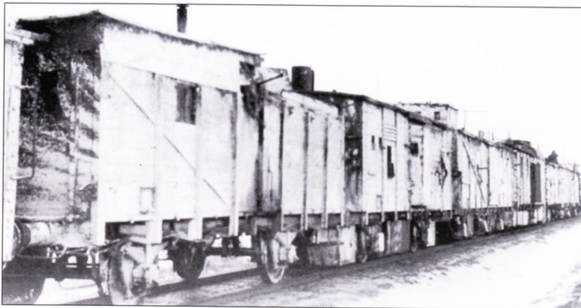
Бронепоезд PZ 7 сформировали на базе тылового охранного поезда и он выглядел внешне как грузовой поезд.
