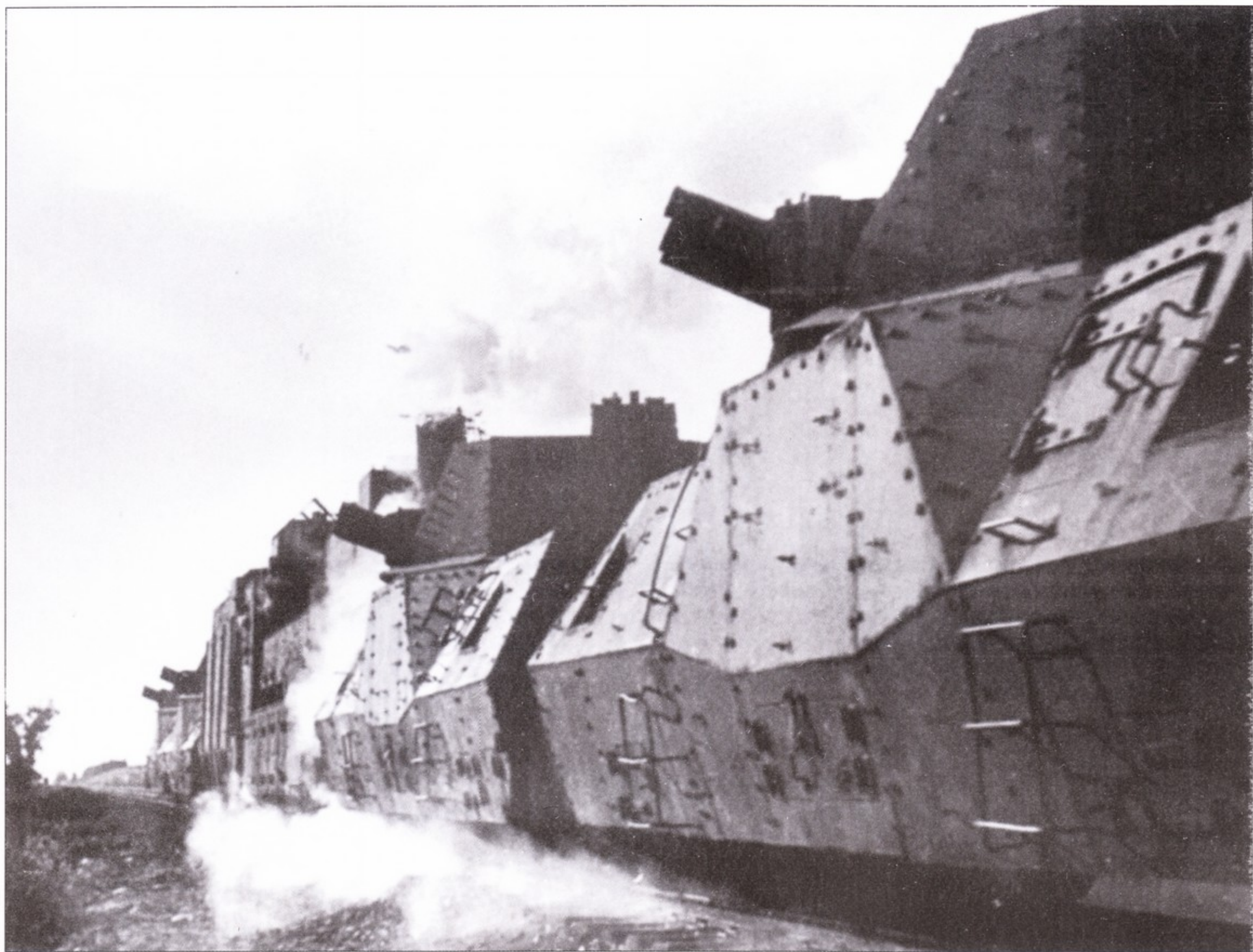
Тяжелые потери бронепоездов летом 1941 года вынудили активизировать постройку новых бронепоездов в кратчайшие сроки в октябре того же года. На снимке бронепоезд ОБ-3 упрощенной конструкции. В составе ОБ-3 четыре артиллерийских вагона, на каждом по одной башне. Бронированный паровоз типа Ов.
