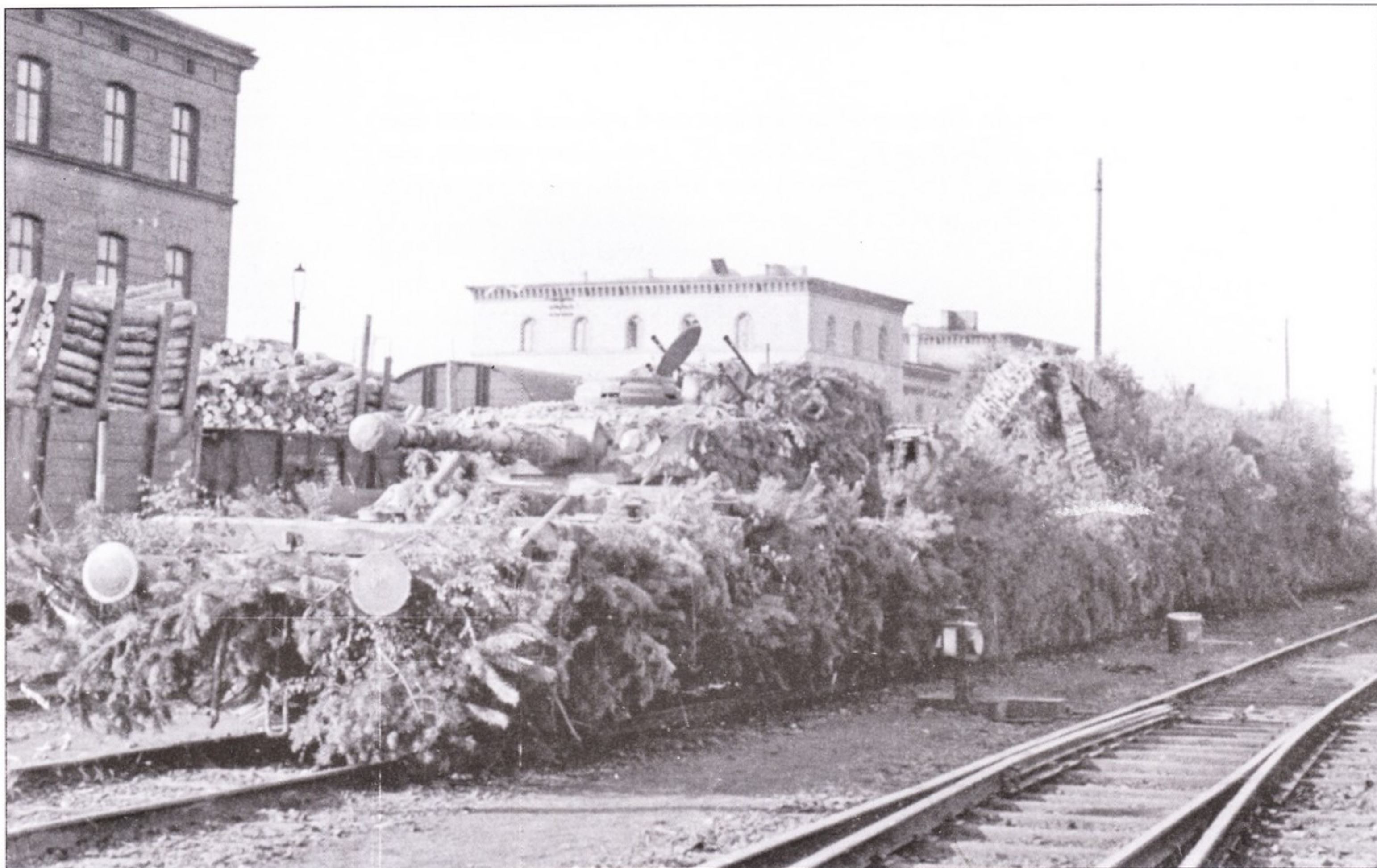
Стандартная конструкция бронепоезда БП-44 включала новый вагон истребителя танков впереди и в конце поезда. При этом использовались башни танка Pz.Kpfw IV. На снимке бронепоезд Pz.75 на станции Хагенау захваченный американской армией в мае 1945 года.
