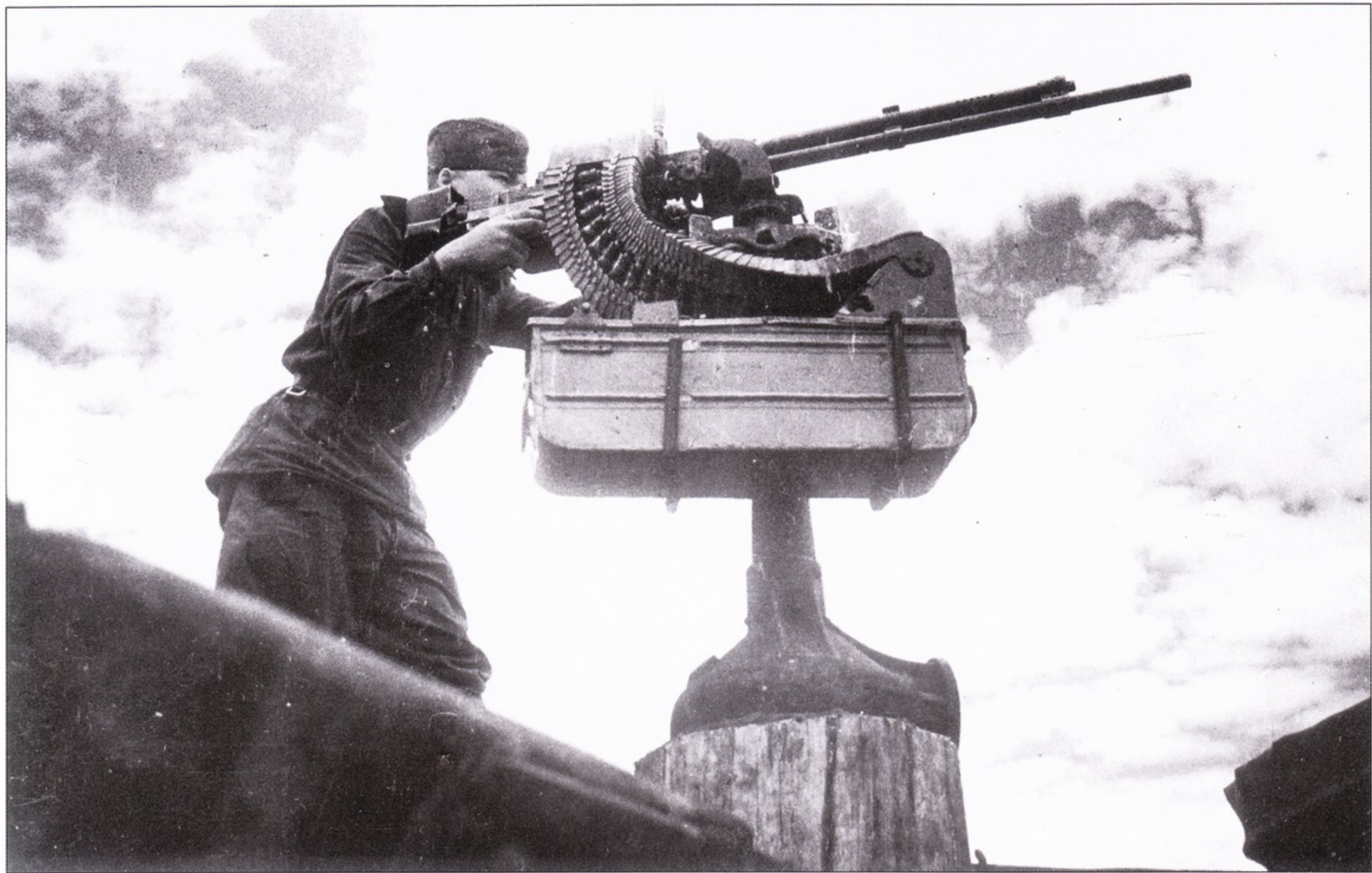
Старший сержант Игнатьев Сергей Павлович у зенитного 12,7-мм пулемета УБТ. Обратите внимание на необычную опору станины пулеметной установки - пень (чисто русское решение вопроса!).
