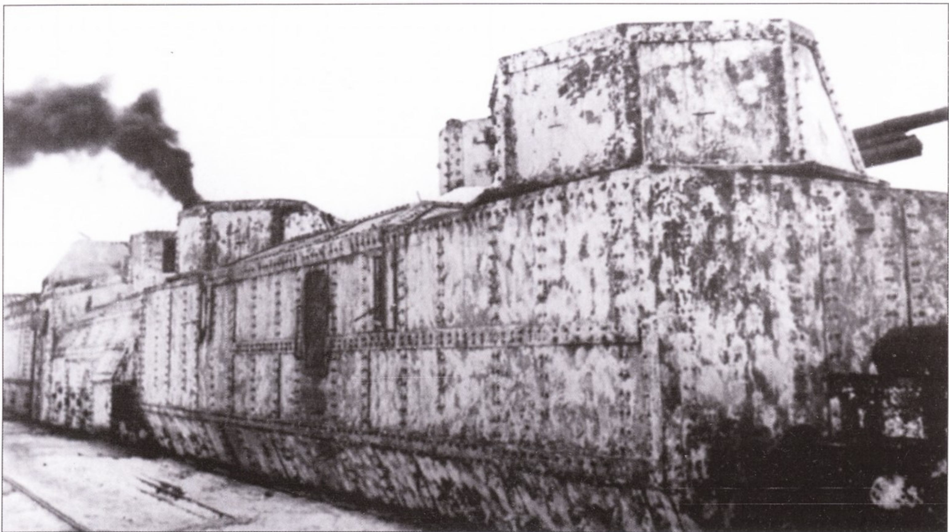
Советский стандартный легкий бронепоезд с двумя артиллерийскими вагонами, каждый из которых вооружен двумя башенными 76-мм пушками. На снимке бронепоезд, вступивший в строй в январе 1942 года.
