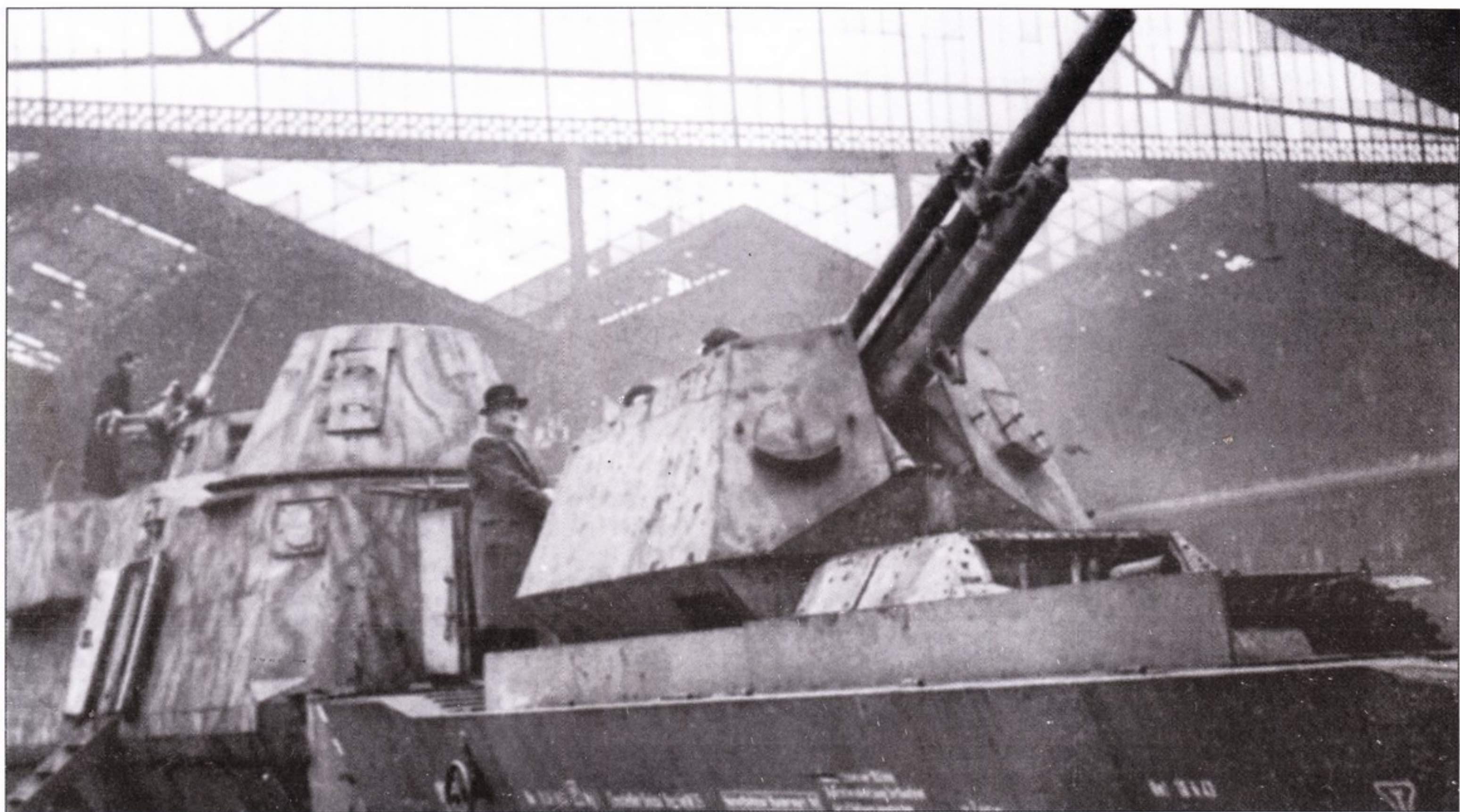
Немецкий бронепоезд Rg.32 союзники захватили 8 сентября 1944 года в Сант-Берайн (Франция). Это один из немногих бронепоездов, действовавших на Западном фронте. На переднем плане – баиня с 100-мм орудием типа I.F.H.14/19 (p), которое прежде стояло на французском самоходном орудии Лоррейн.
