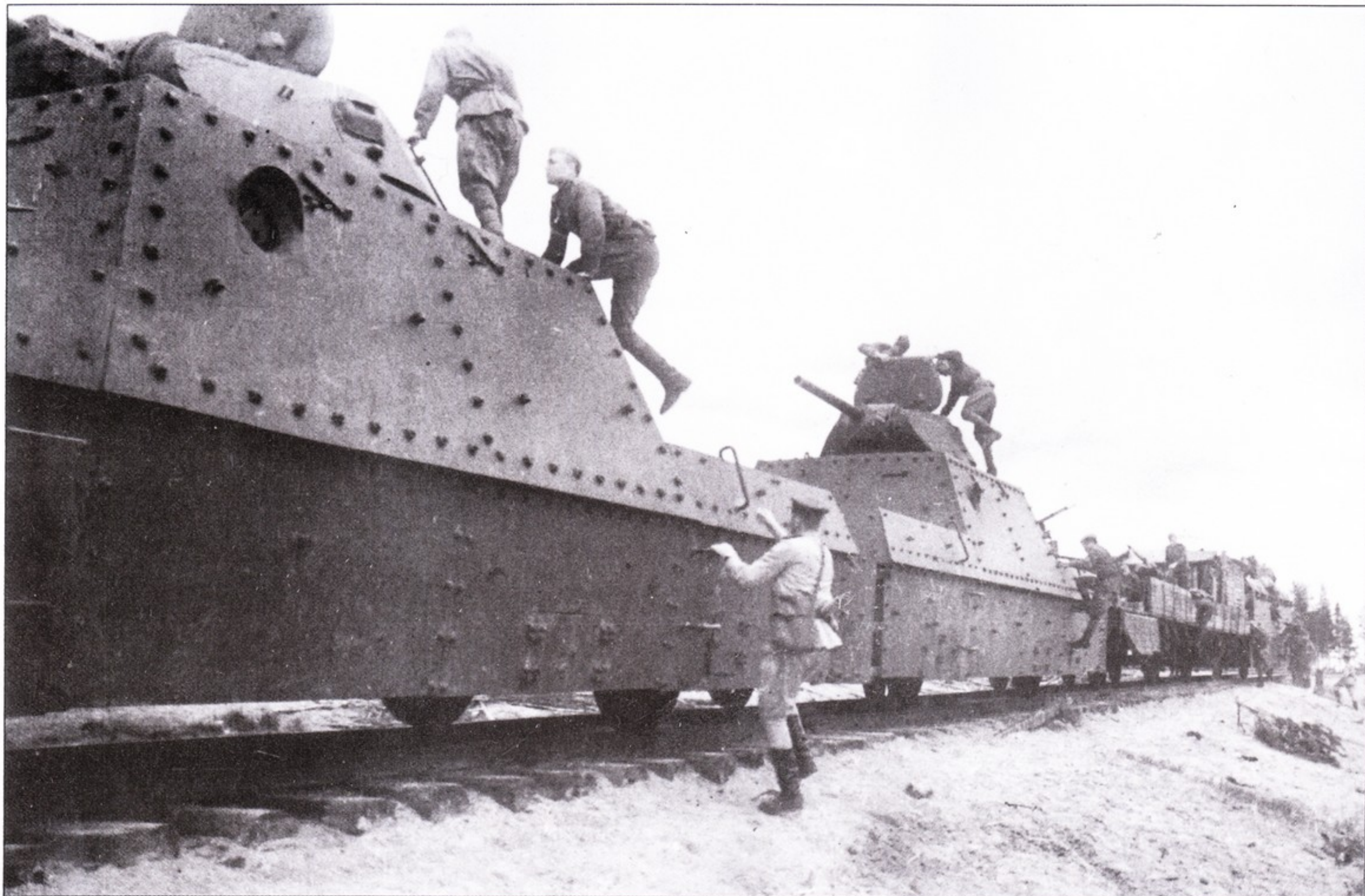
Бронепоезд № 624 «Уфа», снимки сделаны 21 июня 1944 года. Посадка в бронепоезд по тревоге. На переднем плане два артиллерийских од- нобашенных вагона. Башни от танка Т-34 с 76- мм пушкой.
