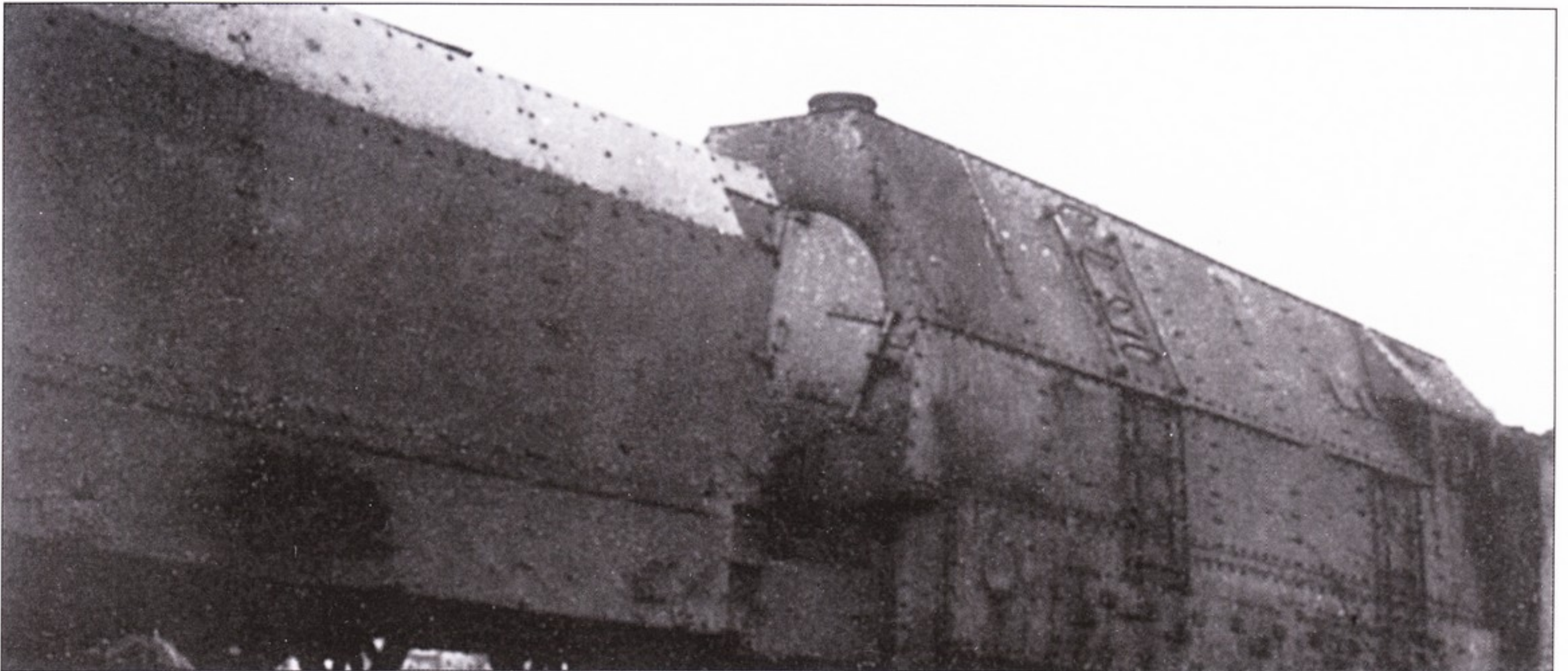
Бронепаровоз серии 57 с дополнительным тендером. На тендере изображена эмблема в виде восходящего солнца, символ бронепоезда № 63.
