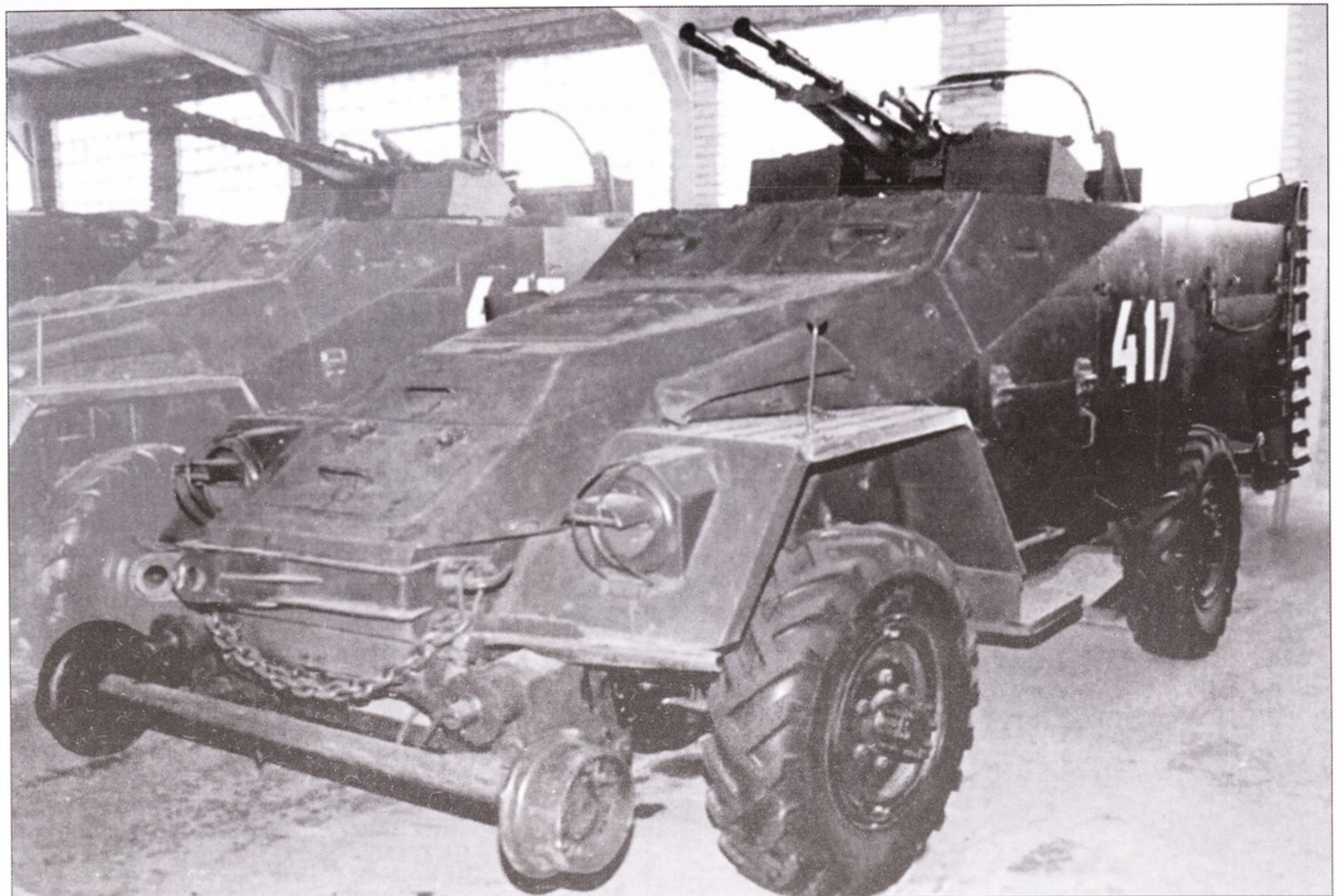
Хотя бронепоезда уже не стояли на вооружении в Советской армии после войны, оставалась идея использовать железнодорожную сеть в военных целях. На снимке БТР-40А (ЖД) оснащенный дополнительными стальными убирающимися колесами спереди и сзади для передвижения по рельсам. Он вооружен зенитной установкой ЗТПУ-2 со спаренными 14,5-мм пулеметами. Эта конверсия построена в 1969 году и просуществовала до 1991 года, когда распался СССР.
