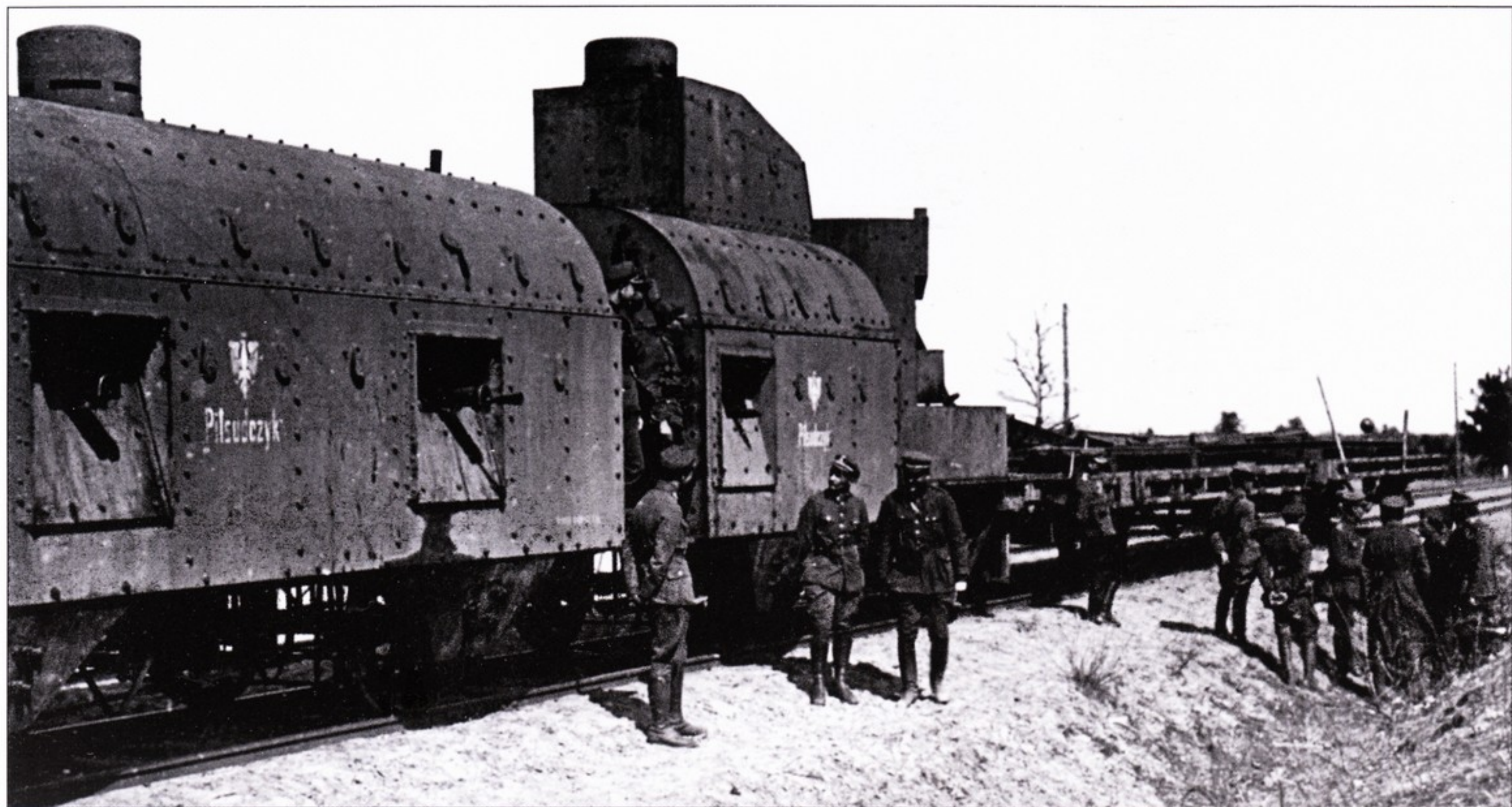
Первый польский бронепоезд Пилсудский собрали из компонентов трофейных австро-венгерских бронепоездов, захваченных в 1918 году. На снимке бойцы штурмовой группы около артиллерийского вагона. Впереди виден контрольный вагон-платформа.
