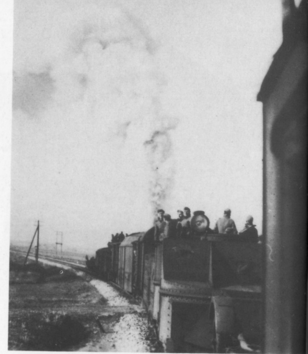
Bilder vom Panzerzug Nr. 23, der aus tschechischem Beutematerial zusammengestellt wurde. Oben links: Der Zug im April 1940 in Dänemark, er trägt noch die Tarnbemalung tschechischer Provenienz. Die anderen Bilder zeigen den Zug später auf dem Balkan. Neben den tschechischen Panzerwagen wurden zwei innen-gepanzerte Güterwagen (wie bei den Bahnschutzzügen) beige stellt. Die Lok ist eine deutsche der Baureihe 93 (Nr. 220). Weitere Bilder siehe Heft I, Seite 9. (1 x ML, 3 x SA)
