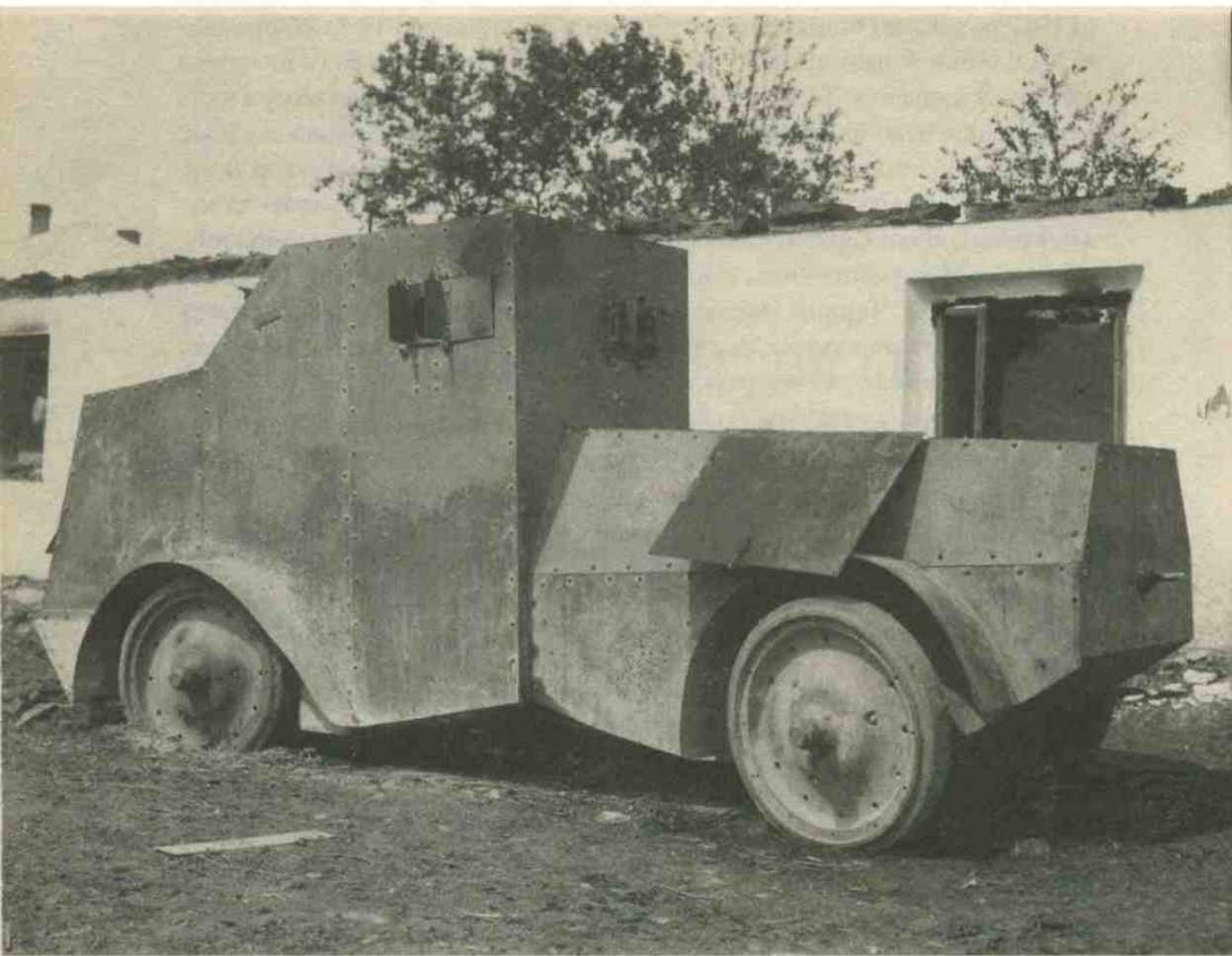
Панцирник, збудований за проектом Віктора Поплавка, літо 1917 р., вид збоку.
