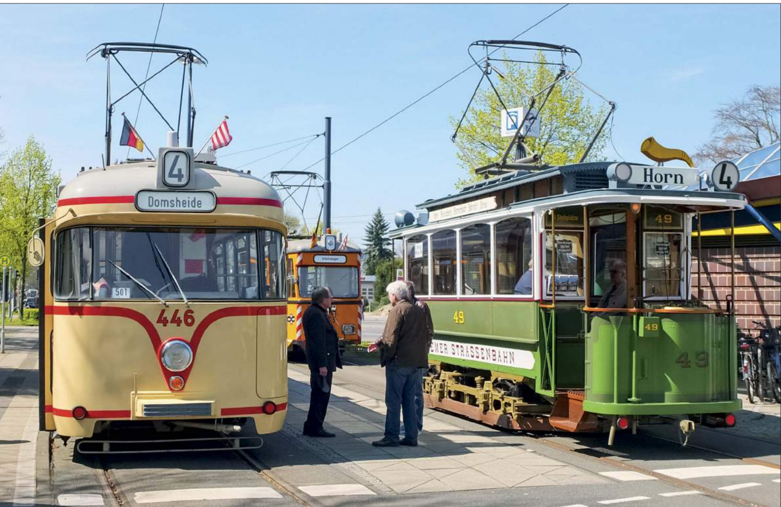
Baujahr 1967 und Baujahr 1900 treffen aufeinander: Hansa-Kurzgelenkwagen 446 und Zweiaxser 49, der vor 117 Jahren im Eigenbau bei der Bremer Straßenbahn entstand. Im Hintergrund zeigt sich der Arbeitstriebwagen 5
