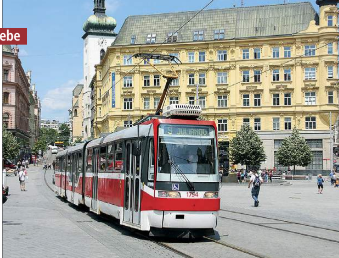
Ein durch Umbau auf Tatra-T3-Basis entstandener Gelenkwagen mit Niederflur-Mittelteil ist der K3R-N – hier eines der beiden vorhandenen Exemplare auf dem zentralen Brünner Platz náměstí Svobody
