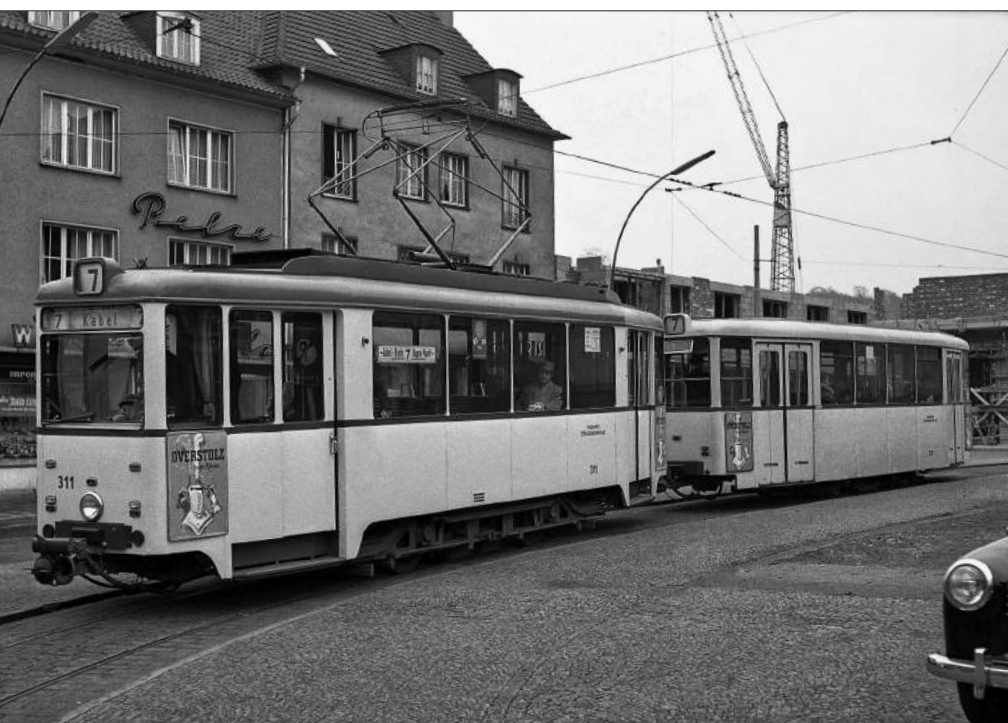
Die 14 Aufbautriebwagen mit handbetätigten Türen waren technisch auch für den Einsatz mit den ab 1954 gelieferten modernen Beiwagen mit automatischen Türen ausgestattet. Wir sehen einen derartigen Zug in der Marktschleife PETER BOEHM, SLG. AXEL REUTHER (2)
