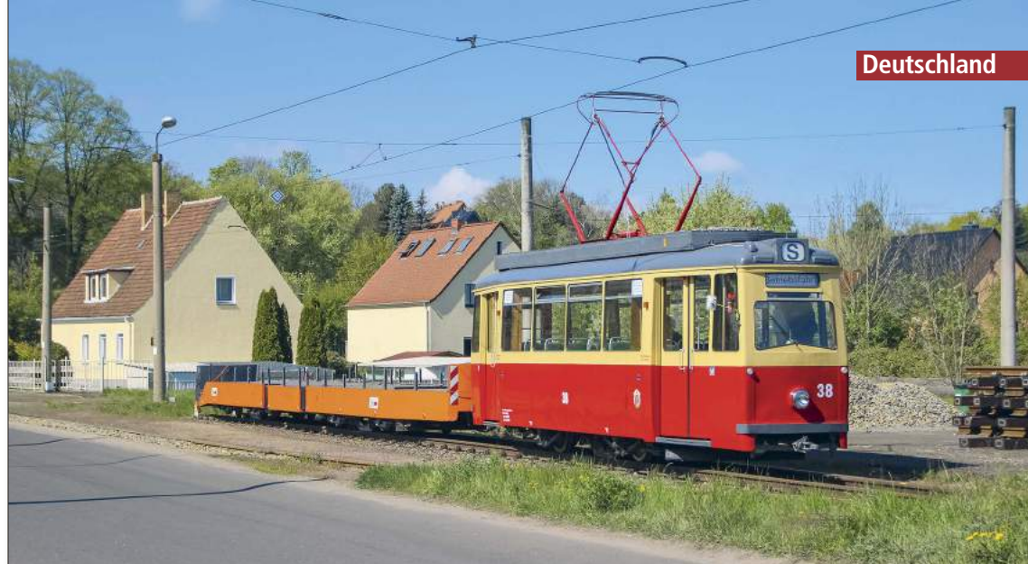
■ Frankfurt an der Oder: Am 30. April veranstaltete der örtliche Verein eine Sonderfahrt mit Lowa-Tw 38 und dem Gelenk-Arbeitsbeiwagen ABw 1. Dieser entstand 1983 bei den Erfurter Verkehrsbetrieben aus Teilen zweier G4-61 und war bis 1992 als ABw 18 im Einsatz. In Frankfurt nutzte die Städtische Verkehrsgesellschaft Frankfurt (SVF) die Arbeitslore 1 hauptsächlich für den Gleismaterialtransport, zuletzt 2016. Zukünftig sieht die SVF keine weitere Einsatzmöglichkeit für den ABw 1 und möchte das Fahrzeug verschrotten
