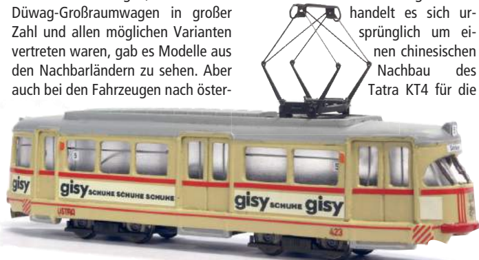
Wolfgang Mönch baute einen Wiener Großraumwagen zum Breitraumwagen seines Heimatbetriebes Hannover um. Charakteristisch sind die „Blumenkästen“ zur Überbrückung des Abstands zu den Tunnel-Bahnsteigen
