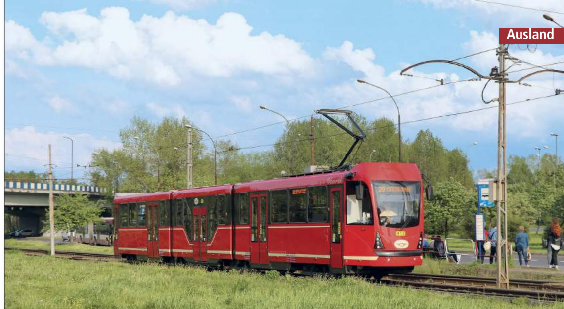
■ Kattowitz/Oberschlesien: Inzwischen fährt bei der Tramwaje Śląskie (TS) mit Tw 913 der erste zum Einrichtungswagen umgebaute früheren Frankfurter Pt, hier am 16. Mai aufgenommen an der Schleife im Kattowitzer Ortsteil Zawodzie. Das Fahrzeug erhielt eine neue Fahrzeugfront, neue Türen und Fenster sowie ein Niederflurmittelteil und besitzt nur noch einen Führerstand
