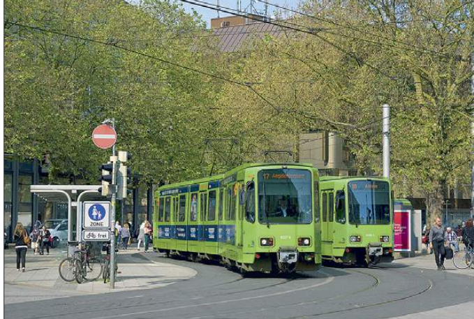
Die bisher in Gleisbögen gelegenen Haltestellen am Ernst-August-Platz konnten nicht zu Hochbahnsteigen umgerüstet werden, insbesondere deswegen dient nun die Streckenverlegung in die Lister Meile als Lösung
