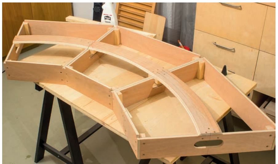
Das N-Modul besteht aus drei Segmenten, die zusammen einen 90-Grad-Bogen mit einem Radius von 81,5 cm (innen) bzw. 84,5 cm (außen) ergeben. Meist ist es einfacher, die Rahmenaufbauten oberhalb der Trasse zunächst wegzulassen und dann später aufzufüttern.
