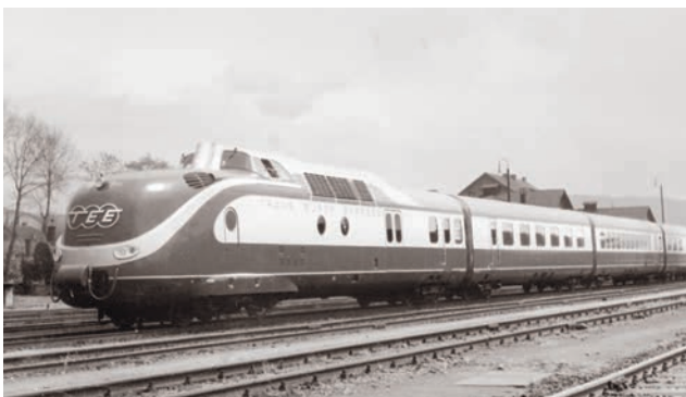
Der Deutsche Siebenteilige Dieseltriebzug VT 11.5, bestehend aus jeweils einem Maschinenwagen an den beiden Zugenden und fünf Mittelwagen: teils Großraum, teils Abteile mit Seitengang, eigener Speise- und Barwagen, Klimaanlage. Insgesamt acht Garnituren.
