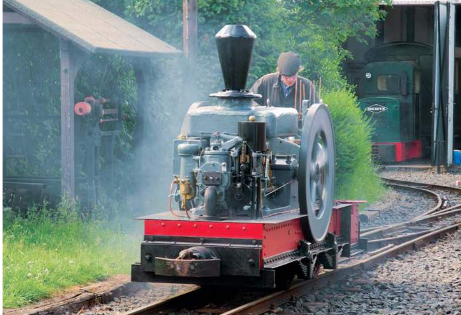
Einer der vielen Schätze im Feldbahnmuseum: Die Benzollokomotive B2 (Oberursel 66095/1913) war erst im April dieses Jahres betriebsfähig aufgearbeitet worden.
