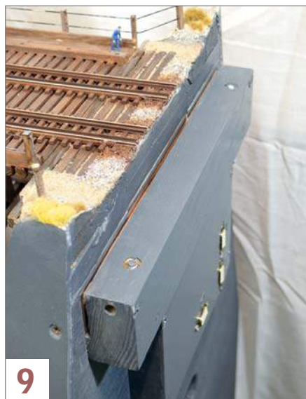
Der Aufnahmeblock mit Schlitz, in den der Aluwinkel des Auslegers einrastet. Die M5-Schrauben dienen der Höhenverstellung.
