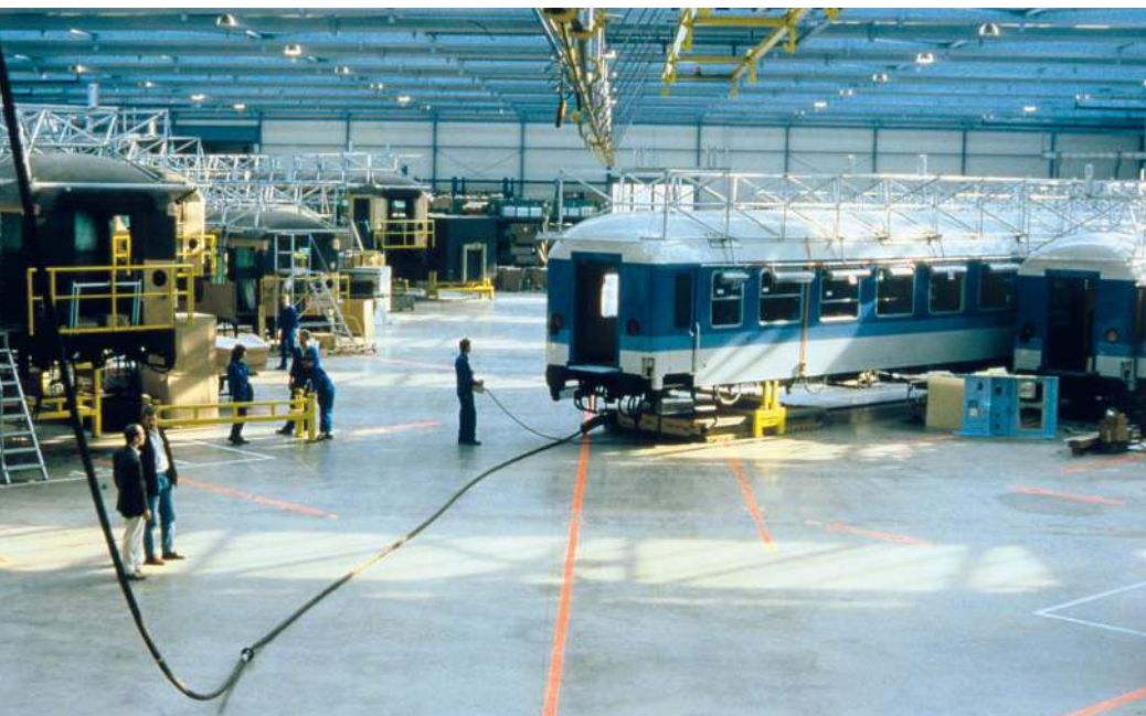
Auf Luftkissen schwebten die Waggons durch die neu errichtete Halle der PFA. Somit war das Werk nicht endgültig auf die Produktion von Schienenfahrzeugen festgelegt.
